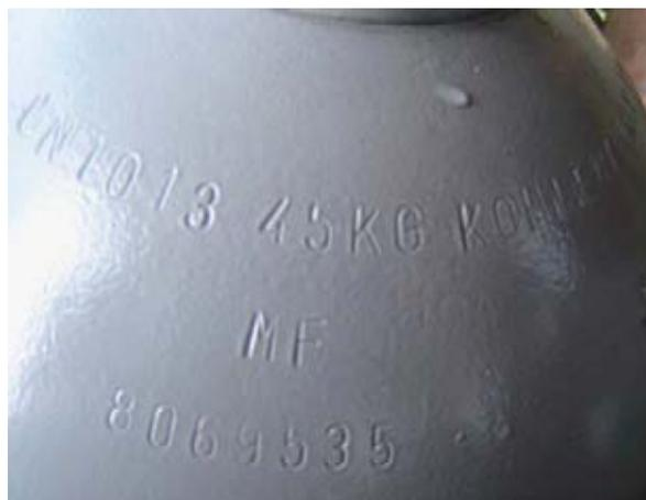
Fig. 1.3.3 - 2) Marcas reglamentarias de las botellas de CO<sub>2</sub>.
