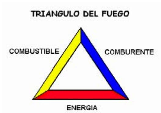
Fig.1.2.1 - 2) Esquema del triangulo del fuego.
