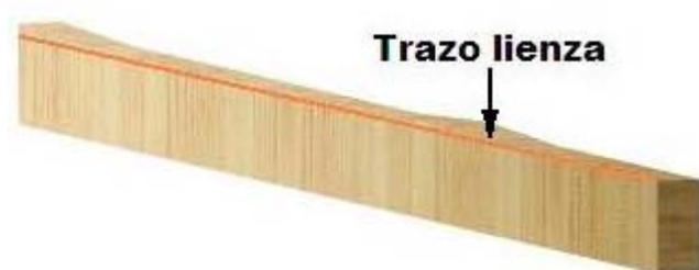
**Figura 5-20.** *Rebaje de vigas. Fuente: Elaboración propia.*
