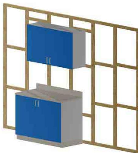
**Figura 5-3.** *Se deben proveer todas las piezas necesarias entre los pies derechos para asegurar un buen anclaje de los muebles murales. Fuente: Elaboración propia.*
