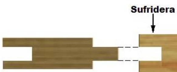
**Figura 5-24.** Para aproximar cada tabla a la anterior se le dan golpes laterales con el martillo, sobre una *sufridera*, o trozo de la misma tabla para no dañar la lengüeta. Fuente: *Elaboración propia.*
