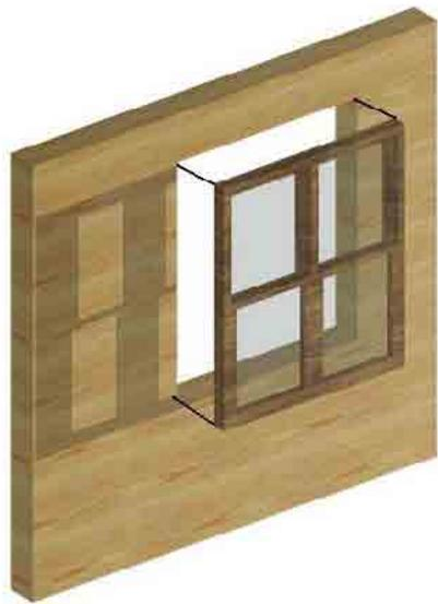
**Figura 5-33.** *Conformar los vanos y después hacer la ventana a medida. Fuente: Elaboración propia.*
