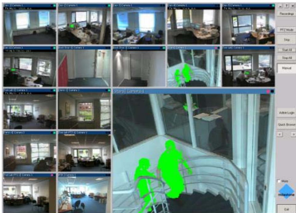
Figura 48, software de gestión de seguridad con detección de movimiento
