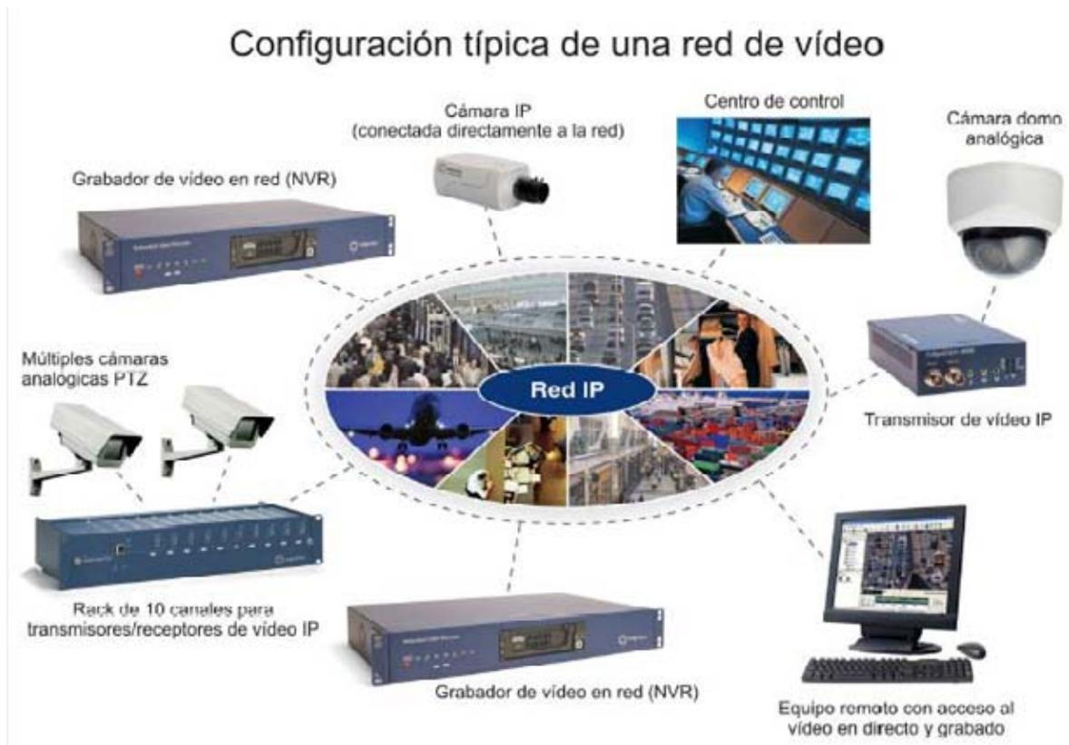
Figura 6, Configuración de una red de video IP de Vigilancia o monitoreo.
