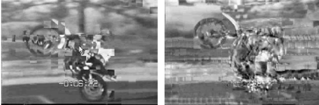
*figura 35, Efectos de la pérdida de paquetes según codificación*
