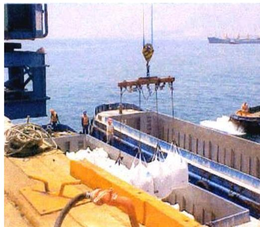
en los refugios de Falucho; el Portalonero indicará al Operador de la Grúa el retiro de éstos, el cual levantará la carga a retirar lentamente, de tal forma de tensar los ganchos y comprobar que las asas están colocadas correctamente.
