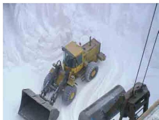
Al terminar la descarga de la bodega y una vez que el Payloader ha retirado todo el producto que la pala por si misma no alcanzó a sacar, se procede a trasladarlo al muelle, tomando todas las precauciones necesarias y siguiendo las indicaciones señaladas, en orden inverso.
