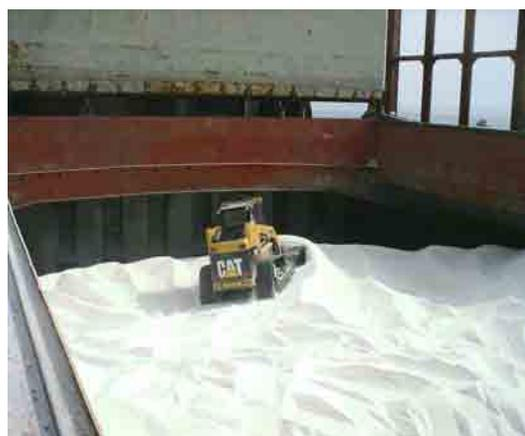
El Jefe de Cubierta deberá evaluar las condiciones interiores de la bodega tales como: temperatura, iluminación, presencia de gases, etc., de tal forma que el ambiente de trabajo sea el adecuado y no represente un peligro para el Operador del Bulldozer.
