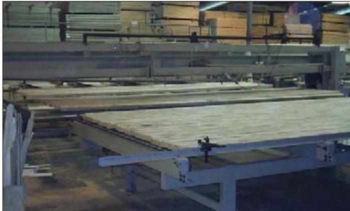
FIGURA N° 74 Mesa de Entrada a la Máquina Moldurera 3
