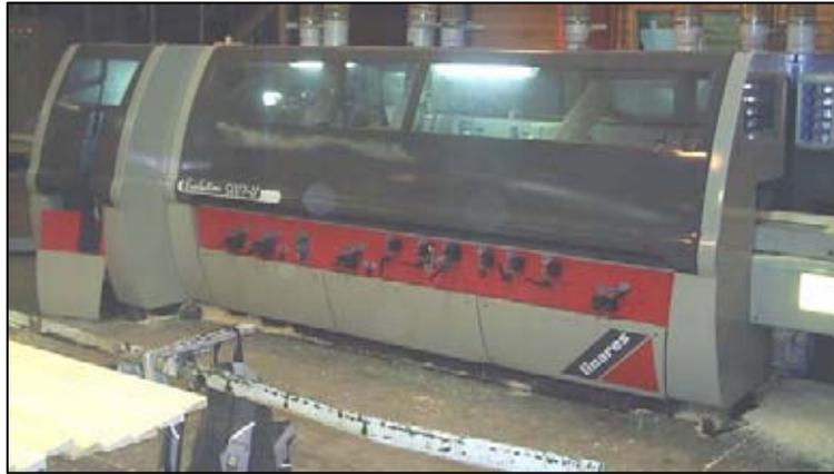
FIGURA N°13 Moldurera Linares Evolution y diferentes molduras.
