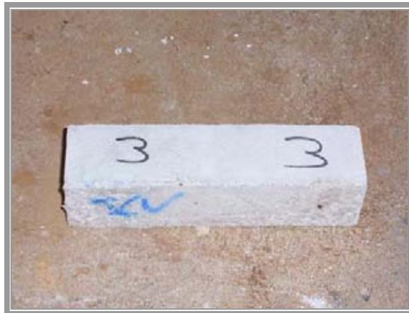
**fotg 8.14 probeta de rilem obtenido de la mezcla de la losa.**
