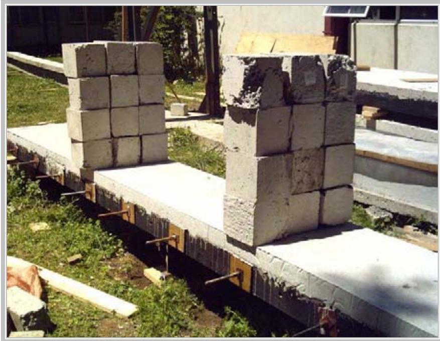
**fot 9.1 Ensayo de carga realizado a la losa mixta.**
