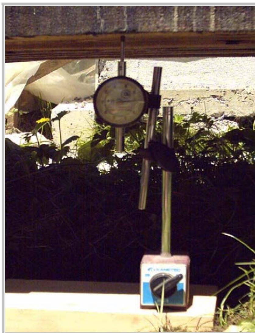
**fot 9.3 disposición del dial que medirá deformaciones sufridas por la losa.**
