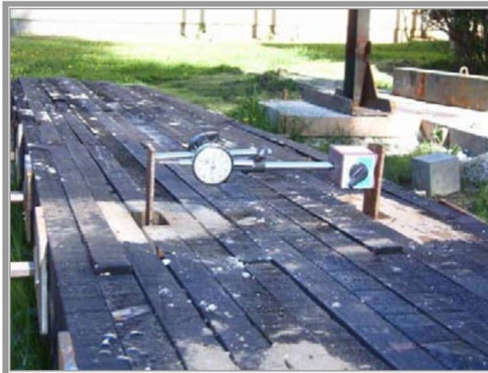
**fot 8.4 colocación del dial entre las dos tableros de 5x20.**
