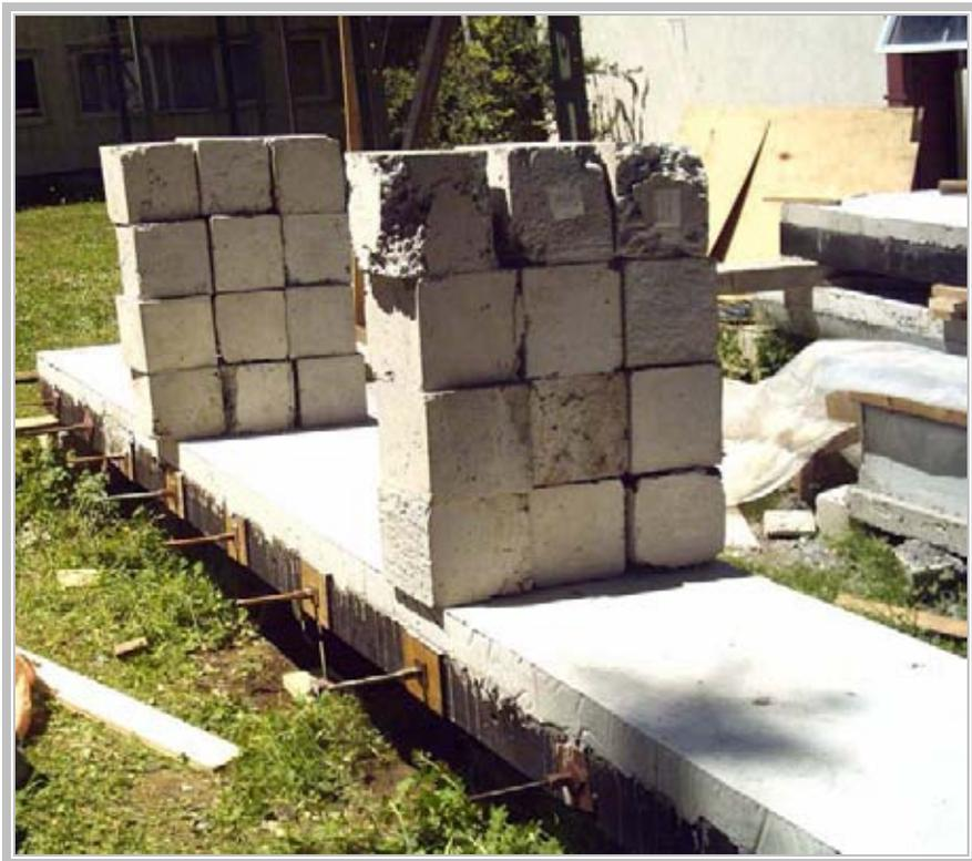
**fot 9.2 Ensayo de carga realizado a la losa mixta.**
