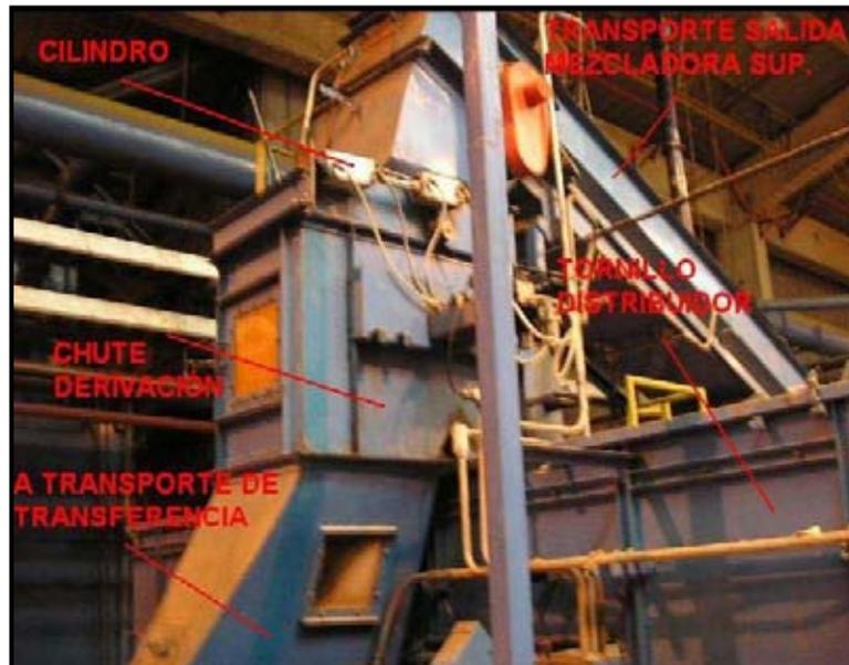
**Figura 2.5 Chute de derivación.**
