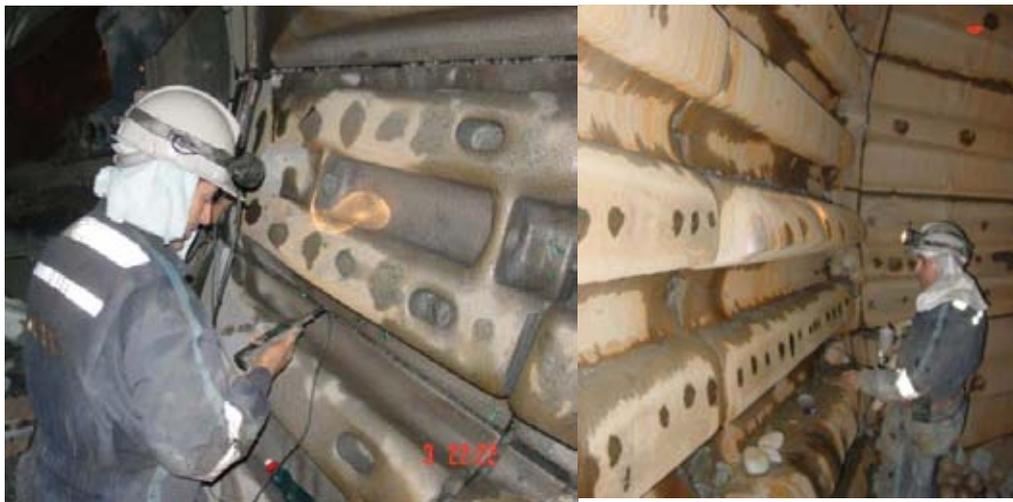
FIGURA N ° 2.12 Control de desgaste revestimientos mediante ultrasonido.
