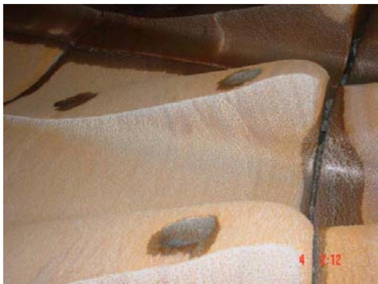
FIGURA N ° 2.9 Desgaste de lifters en tapa de alimentación, molino SAG de 11(m.) de diámetro (Codelco Div. Andina 2004-2005).
