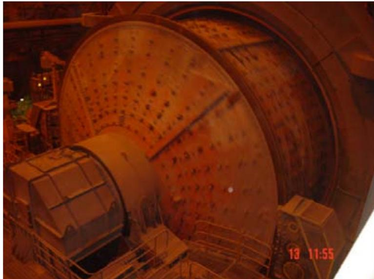
FIGURA N ° 2.1 Molino SAG; 11 metros de diámetro por 4,6 metros de ancho, Planta SAG (Codelco División Andina 2004-2005).
