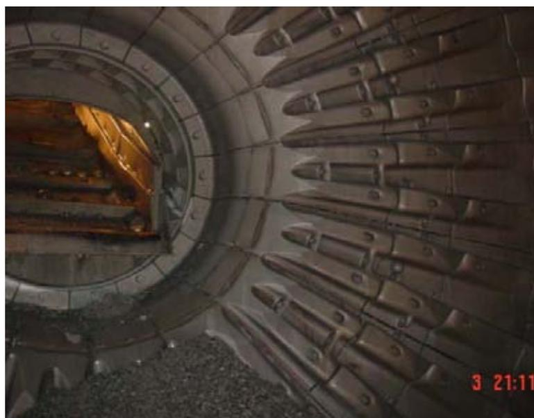
FIGURA N ° 2.10 Desgaste de revestimientos tapa de alimentación en el interior de molino SAG de 11 (m.) de diámetro (Codelco Div. Andina 2004-2005).
