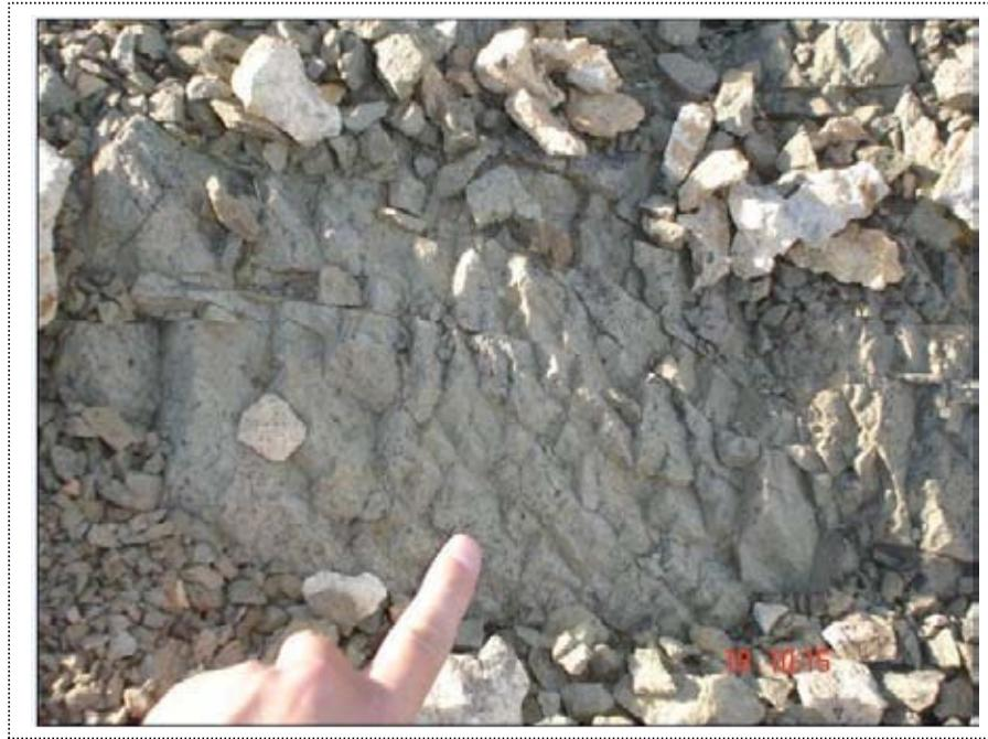
Figura A1.1: Descomposición de Roca a Clastos, Cerro Divisadero, Quebradas Las Lengas Oriente.
