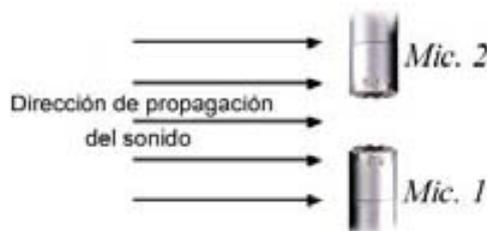
Figura 7.1. Primera situación simulada. Sonda ubicada en forma perpendicular a la propagación del sonido.
