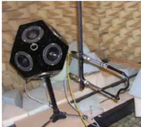
Figura 7.21. Medición al interior de cámara anecoica con Sonda de Intensidad.
