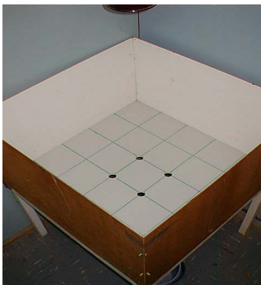
Foto 4: Tablero de campo abierto con agujeros.
