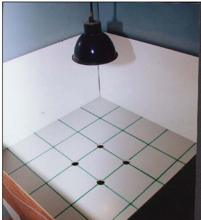
Foto 4: Tablero de campo abierto con agujeros.
