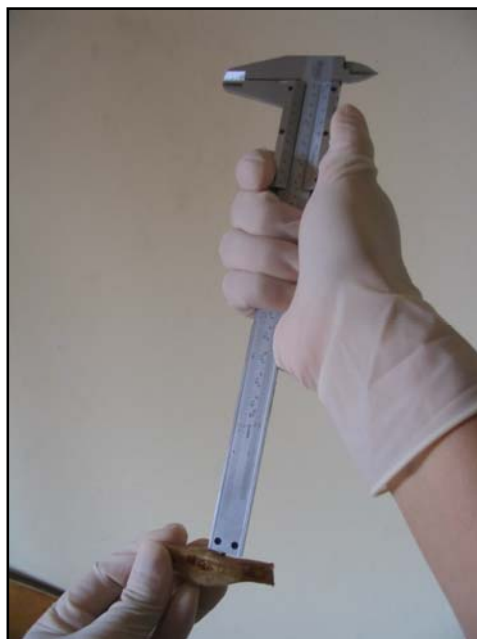
Figura 5. Medición de las depresiones horizontales de la superficie flexora del hueso navicular utilizando un pie de metro.
