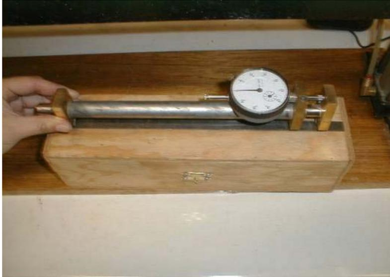
Figura N°4: Dial medición expansión lineal.
