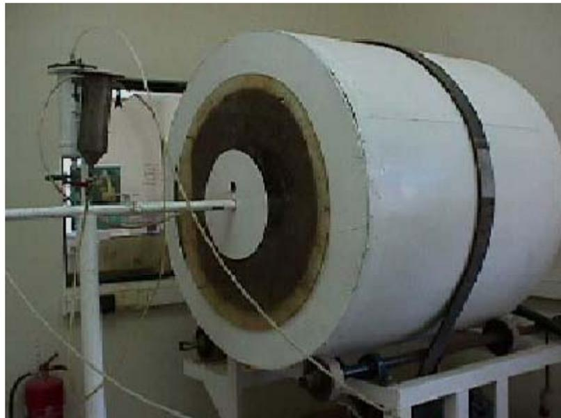
Figura N°11: Encoladora de tambor y sistema de pulverización.
