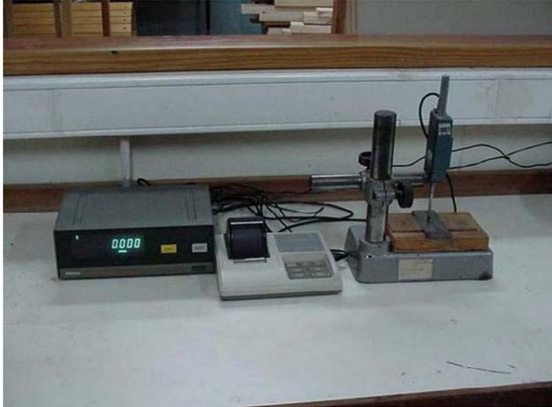
Figura N°8: Medidor lineal de espesor Mitutoyo.
