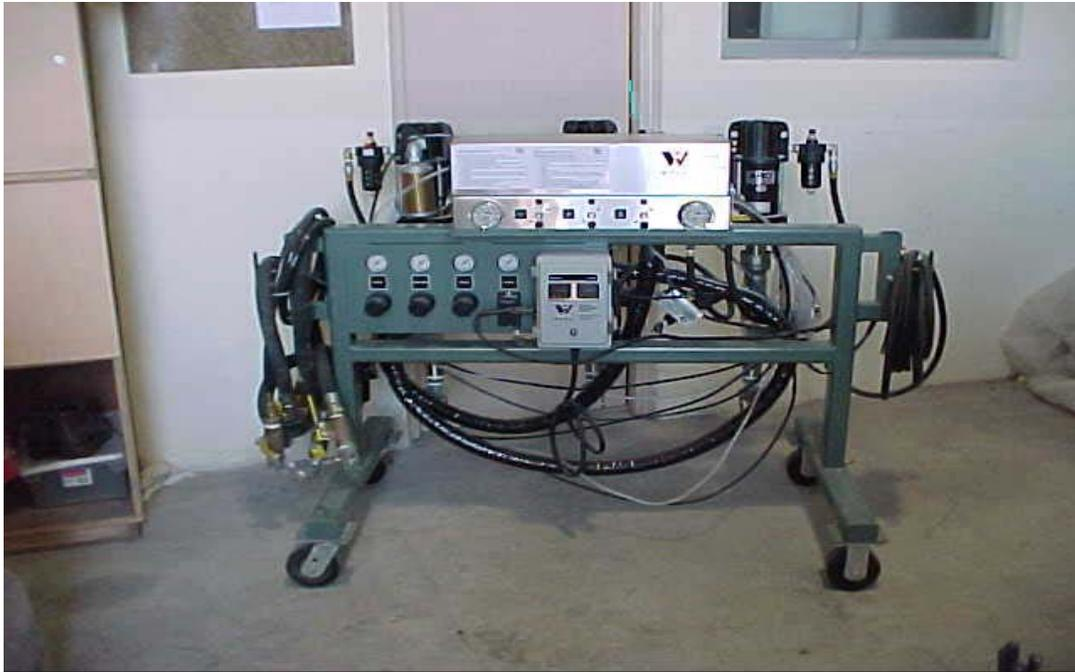
**Figura # 1 : PANEL FRONTAL / sistema con 3 bombas neumáticas**
