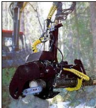
Figura 3. Sierra de cadena (izquierda), Decodificador (centro) y Rodillo mecánico (derecha)
