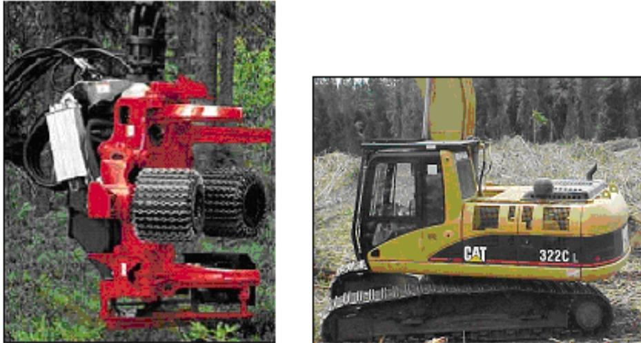
Figura 1. Cabezal WARATAH HTH 620 (izquierda) y Excavadora CAT 322 C<sub>L</sub> (Derecha)
