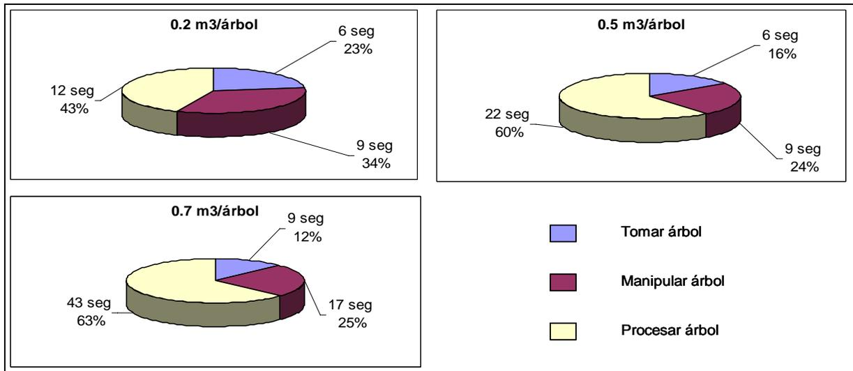
Figura 7. Tiempo medio (segundos) por elemento del ciclo productivo en árboles de 0,2, 0,5 y 0,7 m<sup>3</sup>
