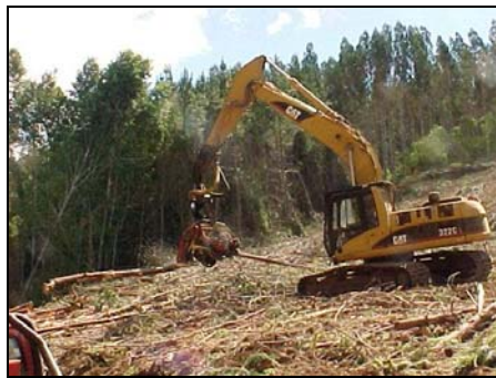
Figura 2. Desrame y trozado con procesador.
