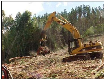
Figura 2. Desrame y trozado con procesador.
