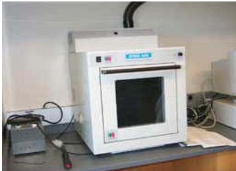
Foto N° 6: Fotografía del Horno Microondas Milestone, modelo Ethos 1600, utilizado para realizar la digestión ácida del elemento As.
