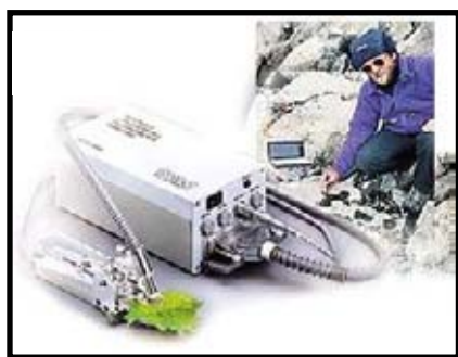
Fig. 11: Fluorómetro portátil PAM 2000 usado para las determinación de rendimiento cuántico máximo
