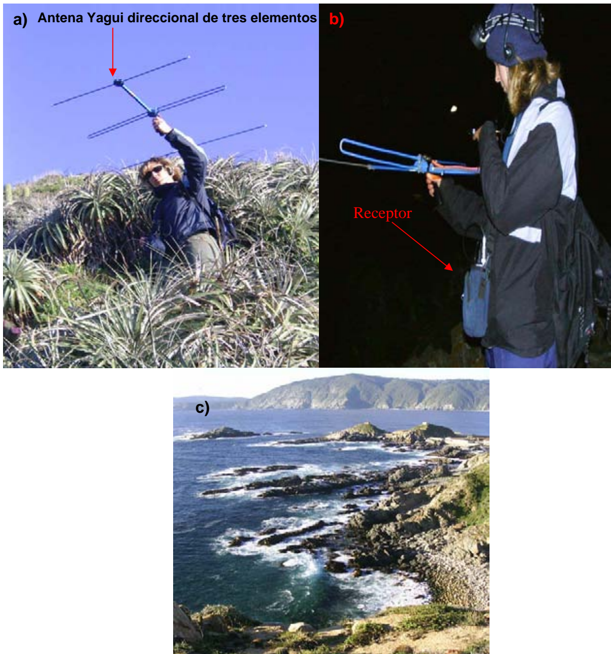
Figura 6. a) Antena direccional de tres elementos (Sirtrack, RA-3 VHF). b) radio telemetría nocturna y receptor (Telonics, TR-4). c) Sitio desde donde se origina la señal recibida por la antena direccional en la costa rocosa de Quintay, V Región de Valparaíso, Chile, 2004.
