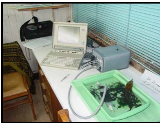
Figura 5. Instrumento portátil, PAM 2000. Permite medir la cinética de conversión de energía y parámetros fotoquímicos en el aparato fotosintético in vivo .
