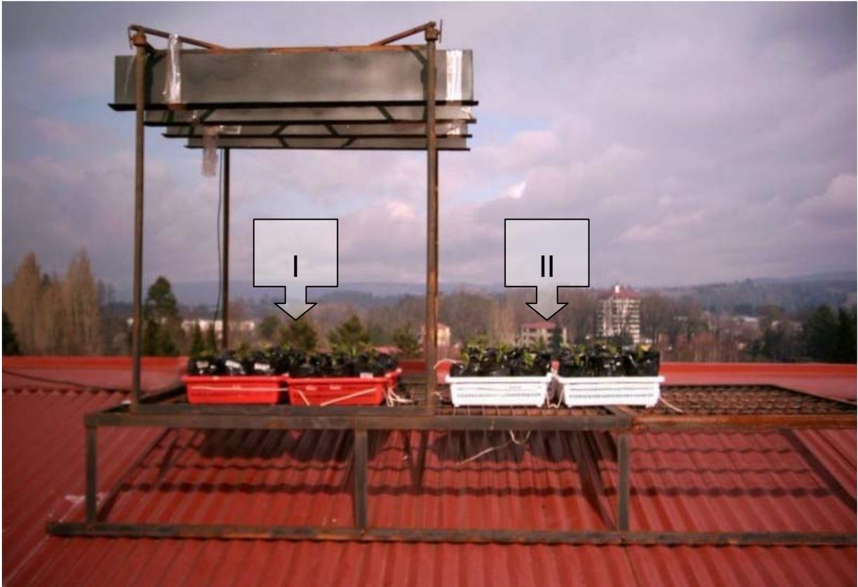
Fig. 7.- Sistema de lámparas instalado junto a la estación de monitoreo de radiación UV-B del Instituto de Física, UACH. La caseta de radiación está provista de cuatro lámparas Q-Panel 313, donde fueron puestas las plántulas de *N. obliqua*, *N. alpina* y *E. cordifolia* para Aclimatarlas al suplemento de radiación UV-B ambiental (I) y junto a ellas fueron puestas las plántulas expuestas solamente a radiación UV-B ambiental (Control) (II).
