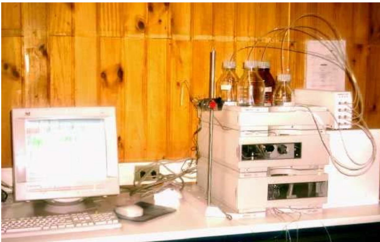
Fig. 14.- Equipo cromatográfico HPLC Hewlett Packard 1100 Agilent de fase reversa con columna Phenomenex Luna  $5\mu$  C<sub>18</sub> (250 x 4.60 mm; tamaño de partícula 5  $\mu$ m) provista de precolumna C<sub>18</sub>  $5\mu$  para eliminar materia en suspensión y contaminantes de los disolventes.
