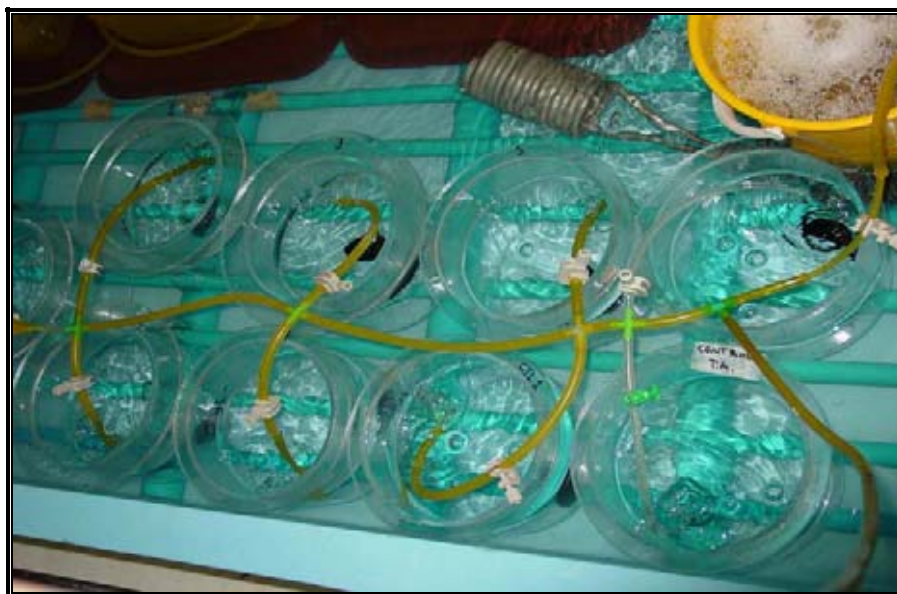
Figura 6. Cámaras experimentales para medir tasa de aclaramiento bajo diferentes concentraciones de toxina paralizante.
