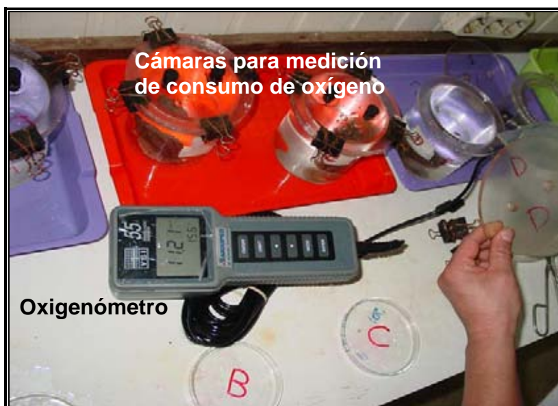
Figura 8. Cámaras de respiración y oxigenómetro para medir consumo de oxígeno.
