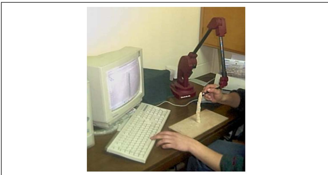
**FIGURA 35.** Captura de puntos de la malla de la réplica de yeso de un espárrago con el brazo digitalizador **Microscribe-3DL™**.
