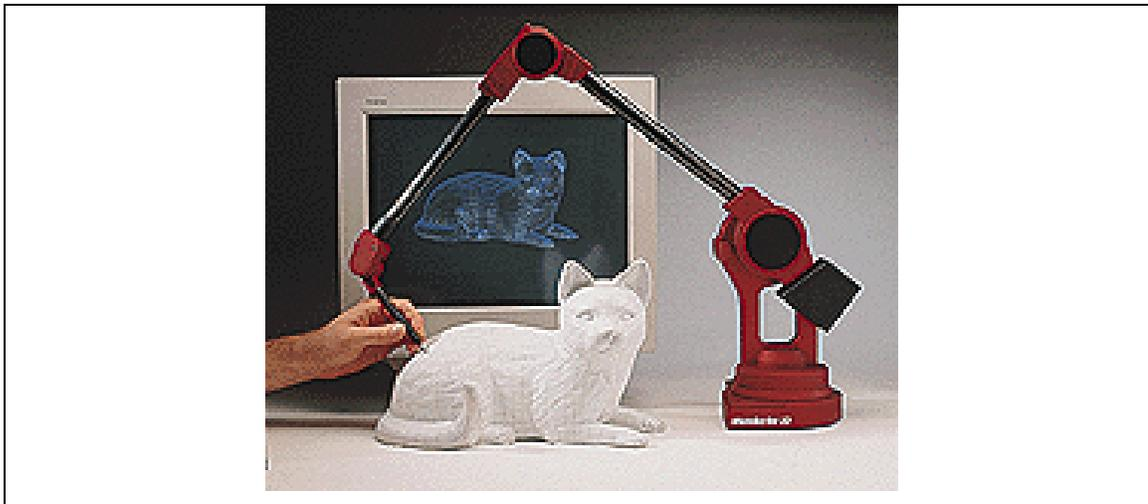
**FIGURA 1. Brazo robótico digitalizador.**
