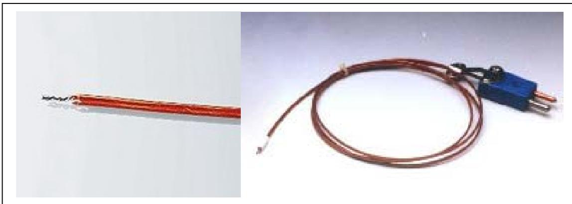
**FIGURA 18. Termocuplas tipo T marca Physitemp® utilizadas.**
