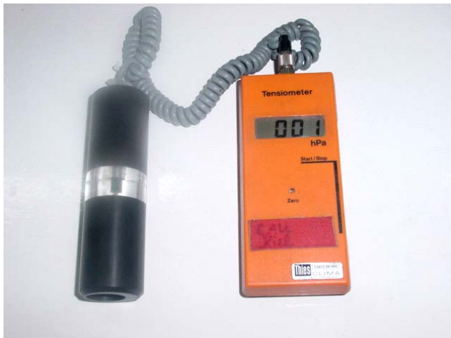
ANEXO 2: lector electrónico del tensiómetro de tubo (sensor de aguja para registrar grado de vacío).
