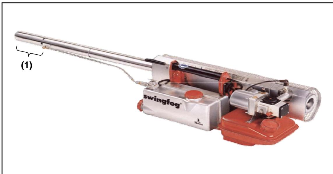
**FIGURA 3** Equipo “Swingfog” tipo nebulizador que fue utilizado para aplicar el inhibidor de brote Chlorpropham. (1) Sección que se introduce en el orificio de la cámara.
