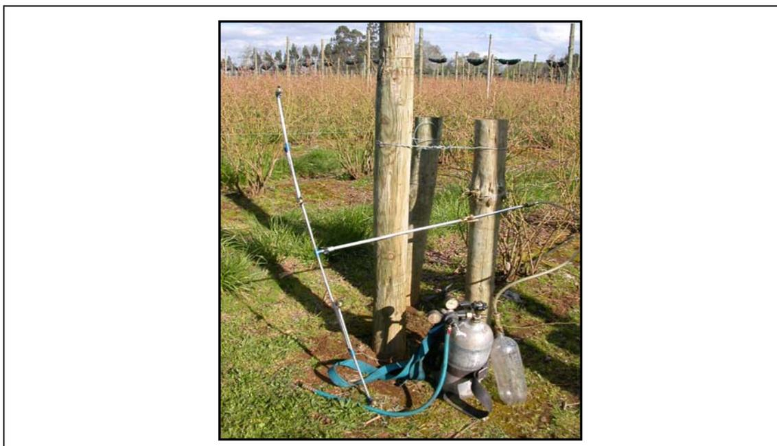
**FIGURA 8. Equipo de CO<sub>2</sub> con regulación de presión, y barra de aplicación con cuatro boquillas del tipo cono hueco, utilizado en las aplicaciones del ensayo.<sup>1</sup>**
