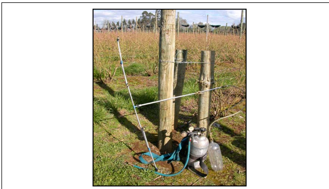
FIGURA 8. Equipo de CO 2 con regulación de presión, y barra de aplicación con cuatro boquillas del tipo cono hueco, utilizado en las aplicaciones del ensayo. 1
