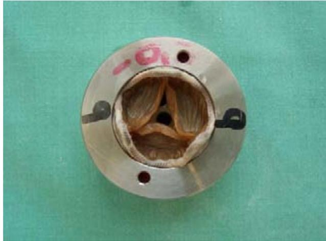
Fig. 15. Anillo con válvula, listo para ser atornillado al émbolo dentro de el compartimiento
