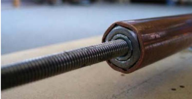
Fig. 34. Tuerca asociada al tubo de cobre por la cual gira el hilo sin fin. De esta forma se producirá el movimiento del tubo y por ende del embolo
