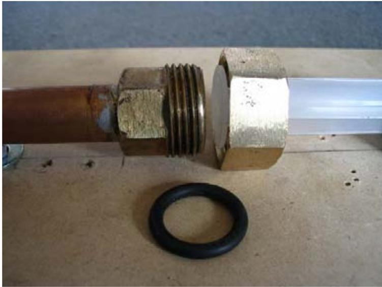
Fig. 39. De esta forma se unen el embolo de la jeringa con el tubo de cobre. Esta pieza los une firmemente pero a la vez permite el rápido reemplazo de la jeringa en caso de ser necesario
