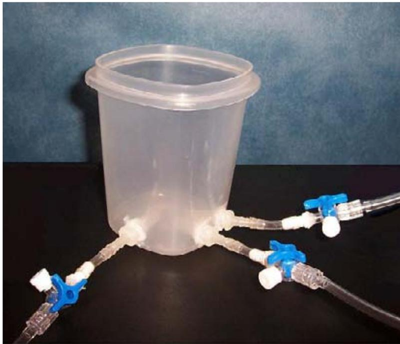
Fig. 43. Contenedor diseñado para realizar la medición y control del pH del líquido que se encuentre en el interior de este.
