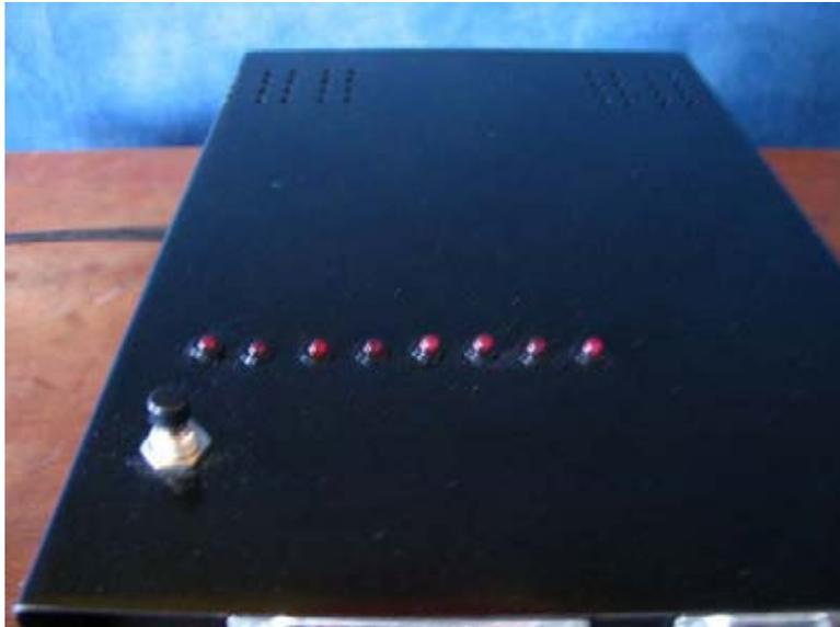
Fig. 56. Medidor de pH, se observan los Leds que indican la palabra digital interpretada por el conversor según la señal entrante. El pulsador es un reset del conversor, que es utilizado para reinicializarlo y comenzar las lecturas.
