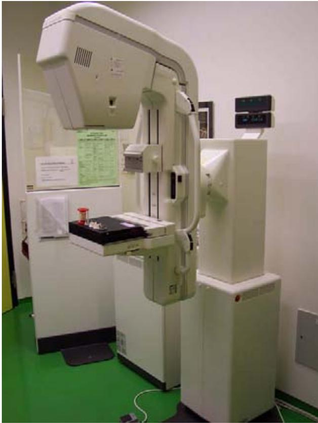
Fig. 19. Aparato para Mamografías (General Electric) utilizado par tomar radiografías a las válvulas bajo estudio. La gran resolución de esta maquina la hace ideal pare este tipo de tareas. E la foto se observan las válvulas en posición listas para ser radiografiadas.
