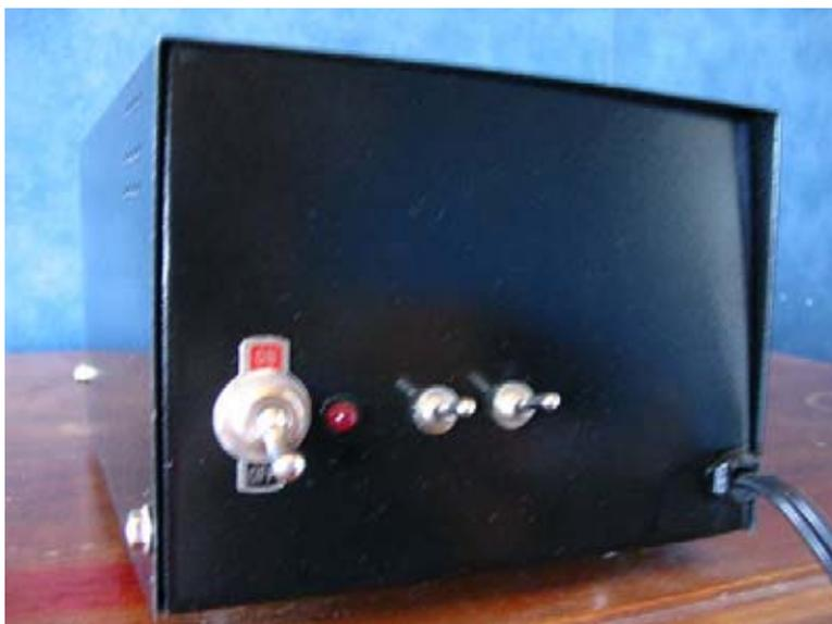
Fig. 55. Medidor de pH, se observan el interruptor de encendido y dos interruptores más pequeños, el de la derecha es para la elección del sensor y el de la izquierda activa el conversor.
