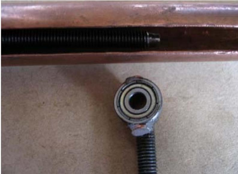
Fig.37. Tubo listo para ser armado, con el hilo sin fin en su interior y sócalo para moverse sobre el descanso
