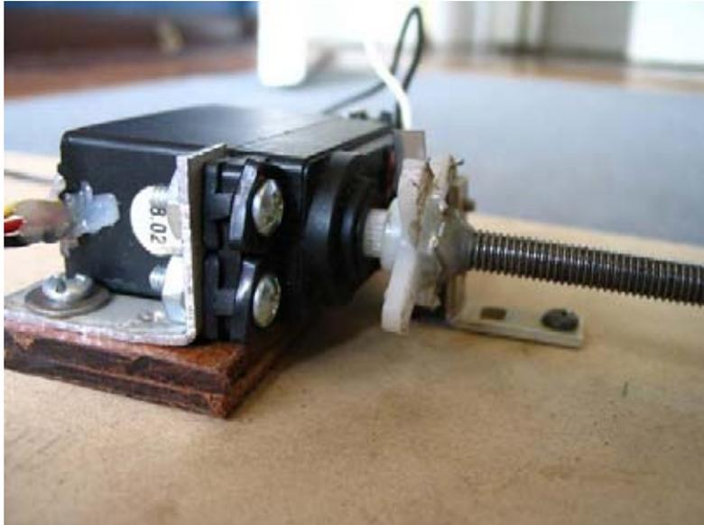
Fig. 32. Hilo sin fin conectado al eje del servo motor. Este hilo es la pieza fundamental del sistema, ya que es el encargado del movimiento de los émbolos de las jeringas.
