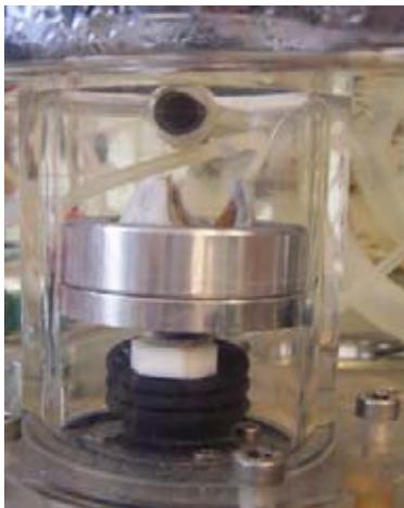
Fig. 16. Se puede observar el anillo con la válvula ajustada y fijado al émbolo dentro del compartimiento.
