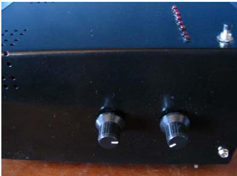
Fig. 57. Medidor de pH, la figura muestra las perillas de calibración. Son los potenciómetros conectados a la etapa amplificadora, uno afecta el factor de suma y el otro el factor de la ganancia.
