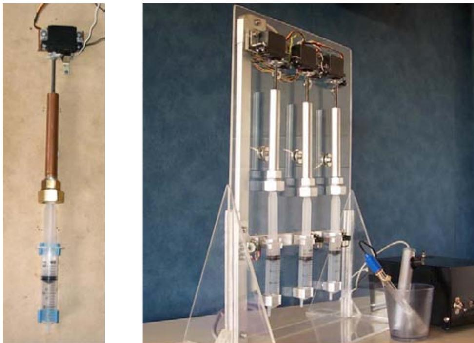
Fig. 40. Izquierda, diseño de pruebas terminado, funcionando en óptimas condiciones. Derecha, el controlador terminado, armado sobre la superficie acrílica.
