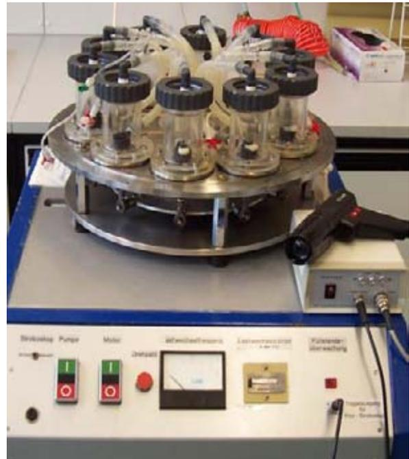
Fig. 13. Simulador junto a un estroboscopio utilizado para observar la apertura de las válvulas en movimiento. Se observan los contenedores, bypass, los émbolos y los discos metálicos
