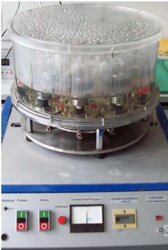
Fig. 18. Simulador cubierto el recipiente acrílico transparente. Los compartimientos se encuentran sumergidos y a 37°C. El agua contiene antibacteriano para evitar malos olores.
