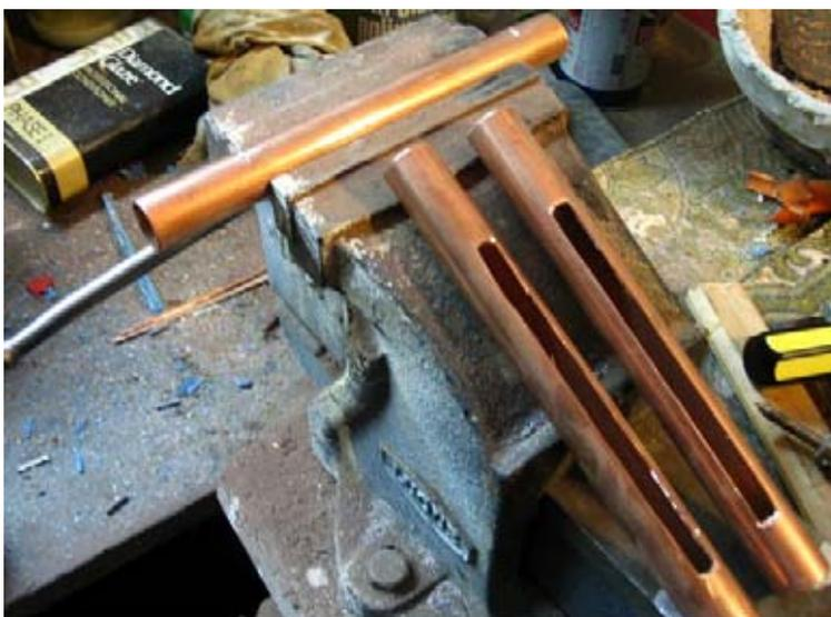
Fig. 36. Tubos con el corte realizado, listos para ser pintados y armados
