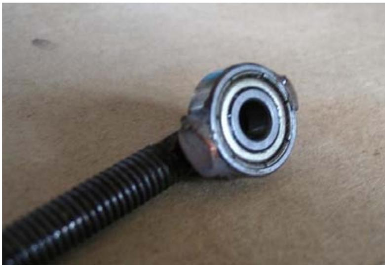
Fig. 33. Descanso donde se posiciona el hilo sin fin. Esta compuesto por un rodamiento de 8 mm. de diámetro externo, 3 mm. de diámetro interno y 4 mm. de ancho. Este rodamiento esta fijado a un perno que sirve de base y que atraviesa la lamina acrílica para ser ajustado.
