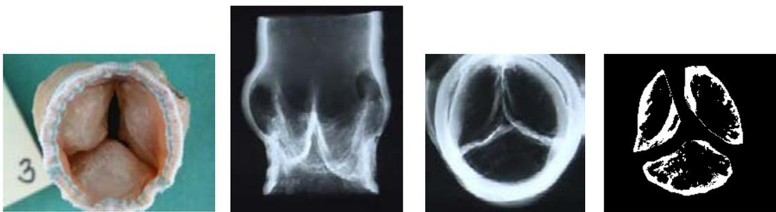
Fig. 20. Esta imagen muestra una secuencia de radiografías tomadas a una válvula con 18 millones de bombeos. Se observa claramente que las valvas presentan calcificación. A la derecha se ve el área de las valvas que están afectadas por la calcificación.
