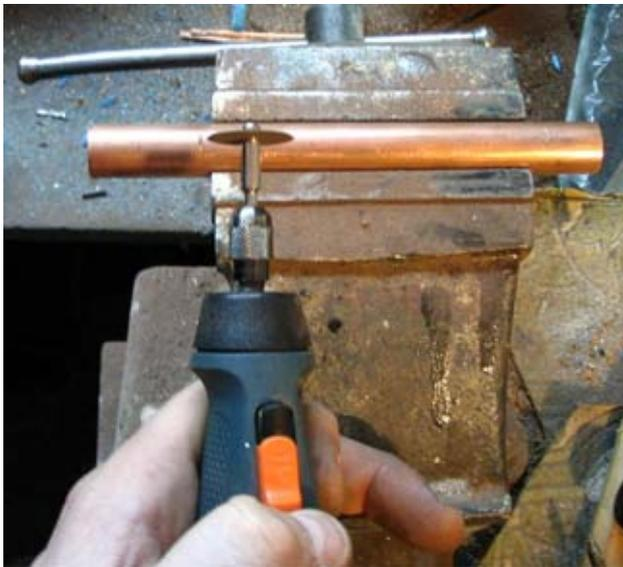
Fig. 35. Los cortes en la superficie de los tubos se hicieron con una herramienta de precisión para obtener así un borde liso y suave que permita el buen deslizamiento del perno a través de el
