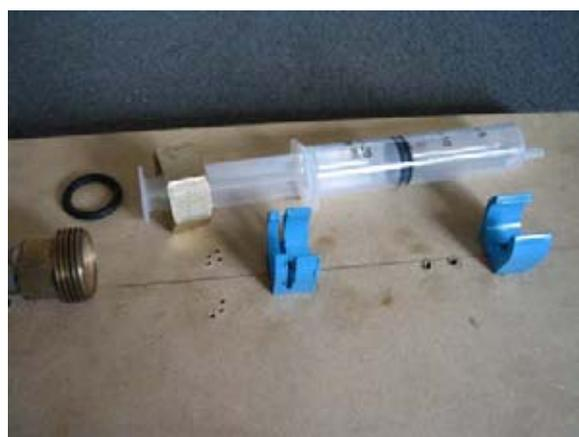
Fig. 31. Soporte para tubería de ½ pulgada plástico deformado con calor para ajustarlo al diámetro de a jeringa. Montado en este caso sobre una superficie de pruebas.
