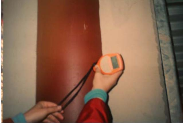
**Figura 3.6: Medición del espesor de la capa de imprimante**
