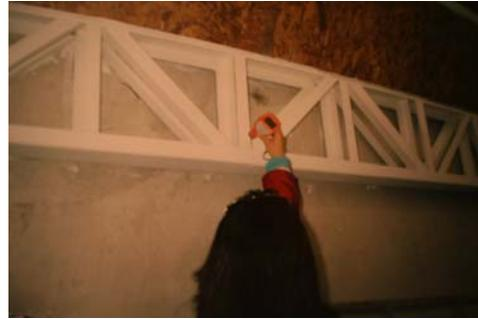
**Figura 3.10: Medición del espesor de la capa Intumescente**
