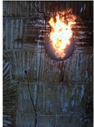
**Figura 4.6: Quemador de gas natural de horno de ensayo.**
