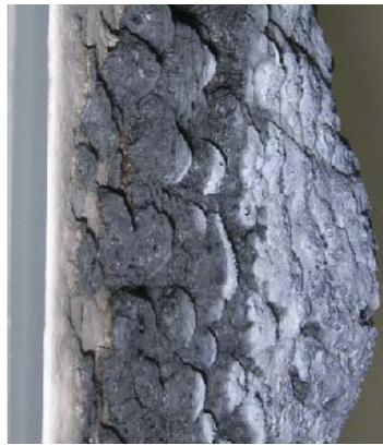
**Figura 3.1: Reacción de la pintura intumescente.**
