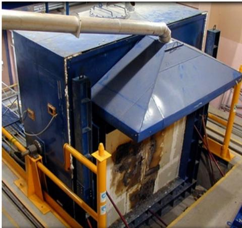
**Figura 4.5: Horno de ensayos de resistencia.**
