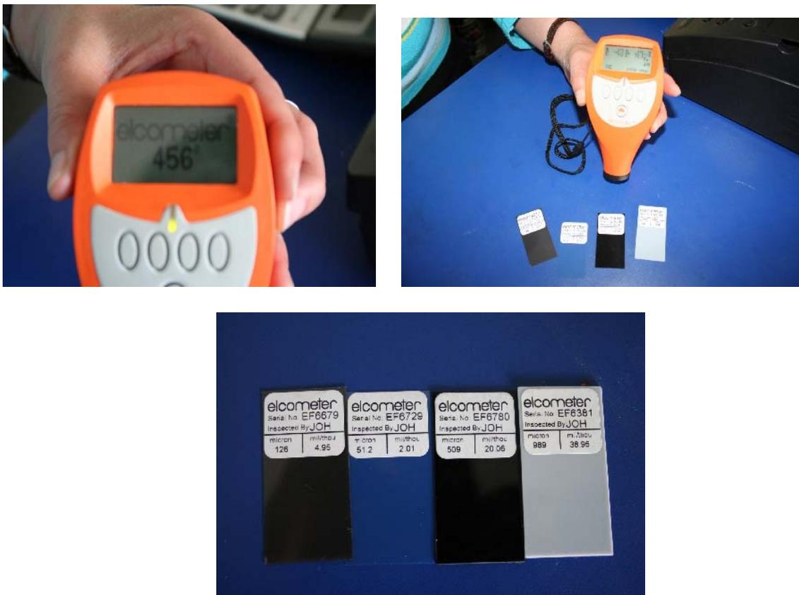
Figura 3.19: Medidor de espesor de imprimante y pintura intumescente.
