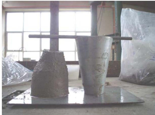
**Ilustración 3.5:** Ensayo cono reducido
