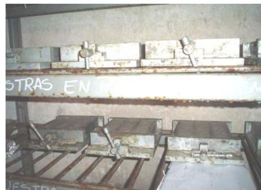
**Ilustración 3.2:** Probetas rilem en cámara Húmeda
