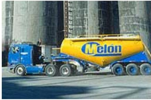
**Ilustración 2.3:** Camión granelero
