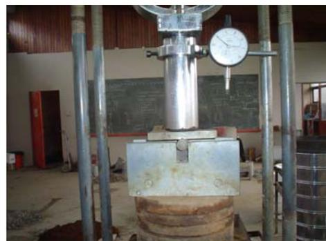
**Ilustración 3.3:** Ensayo de compresión
