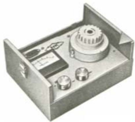
Fig.5.3. Comprobador de sensibilidad del detector.
