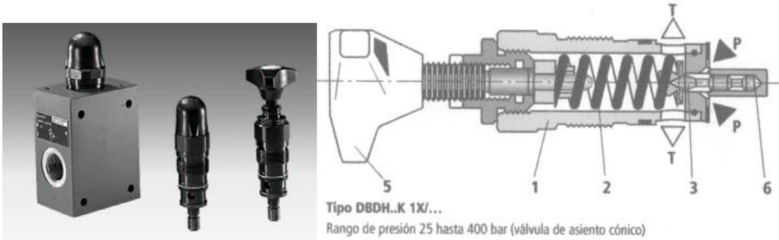
Figura 11.6 Válvula Limitadora de Presión N°12 del Circuito Principal
