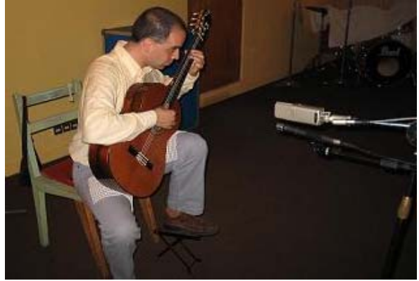
Foto 10. Sistema M-S ch1 al centro cardioide ch2 izquierda desfasado ch3 derecha.
