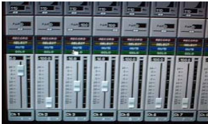
Figura 40. Vista mas cercana de los niveles de entrada de la señal. Canal 3 y 4 con el panpot a la izquierda y derecha respectivamente.
