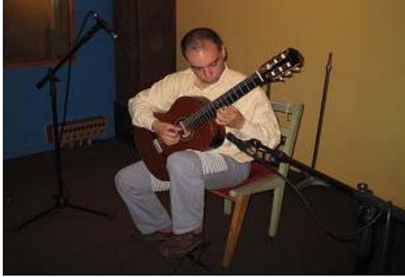
Foto 8. 2 Shure 94 ch1 izquierda oblicuo arriba (panpot izq) ch2 derecha en el plano de la tapa (panpot der.)
