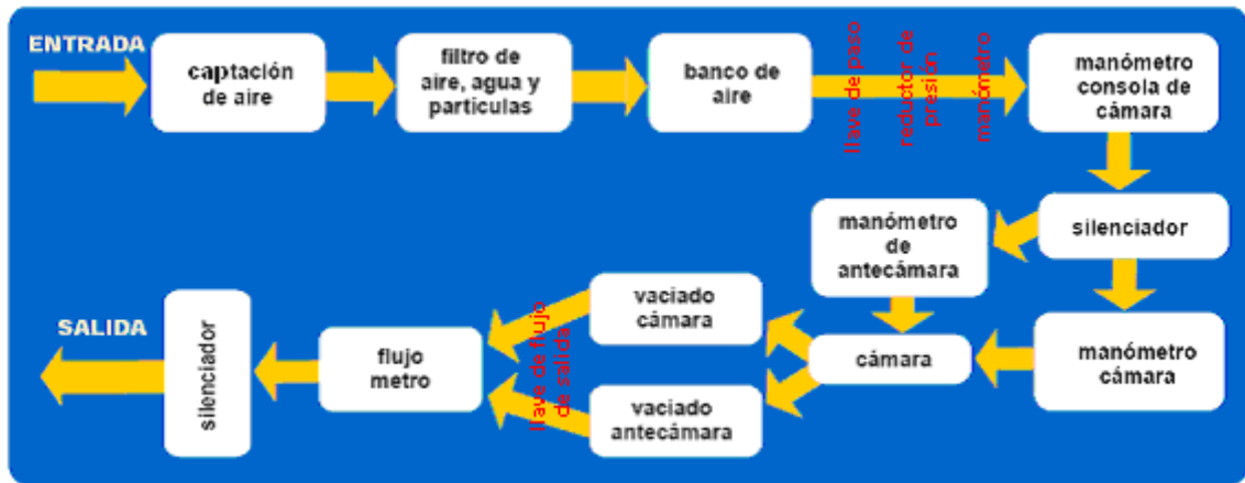
FIGURA N° 1-8 Esquema flujo de operación cámara hiperbárica. Fuente: Guía para un buceo seguro, 2003.
