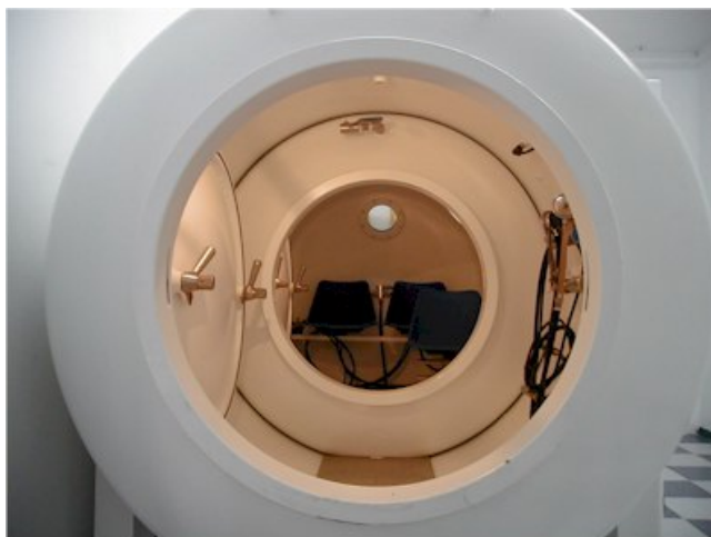
FIGURA N° 1-10 Antecámara. Fuente: IBERCO España.
