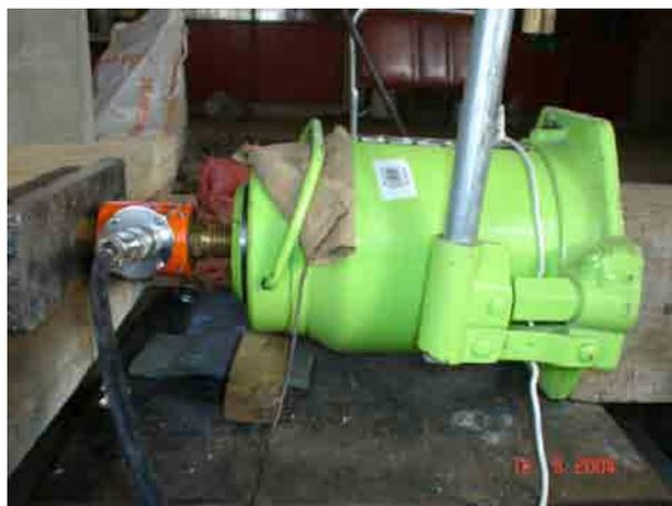
**Figura 9.13** Detalle de celda y gato hidráulico.
