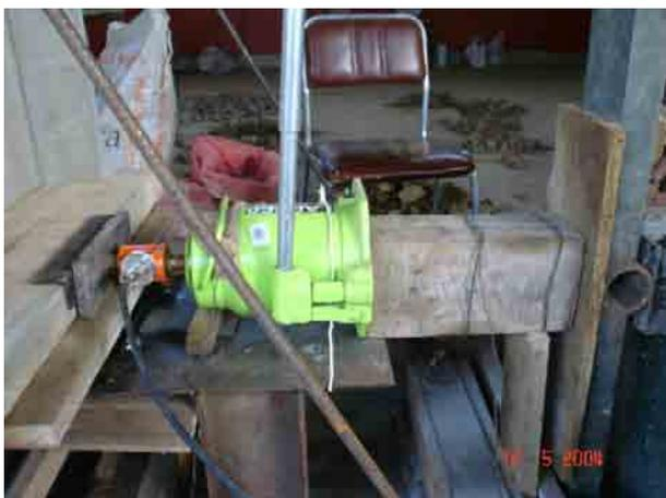
**Figura 9.12** Disposición de celda y gato.
