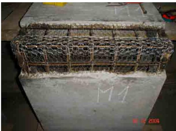
**Figura 8.36** Vista de suples instalados.
