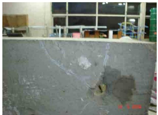
**Figura 9.37** Fisuras en zapatas.
