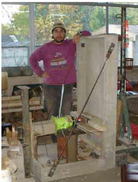
**Figura 9.8** Muro listo para ensaye.
