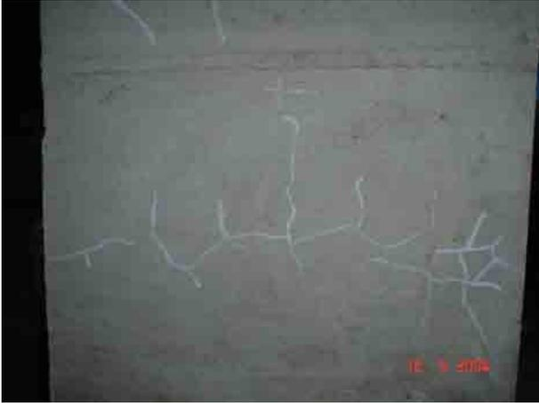
**Figuras 9.32 y 9.33** Fisuras externas del muro (superficie en tracción). Principio agrietamiento y luego del colapso.
