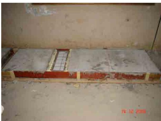
**Figura 8.24** Descimbre de la estructura.
