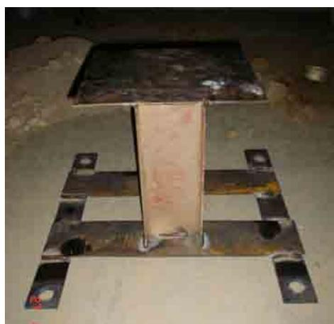
**Figura 9.4** Estructura soporte gato – celda.
