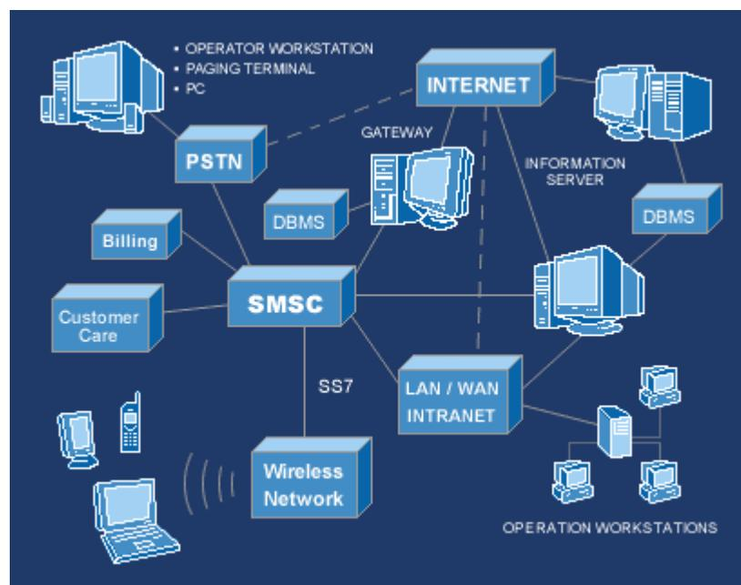
**Figura N° 4: Infraestructura de red básica para servicios de SMS**
