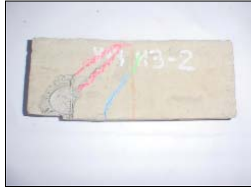
Foto 4.1 15 Grietas viga 3 modelo 3
