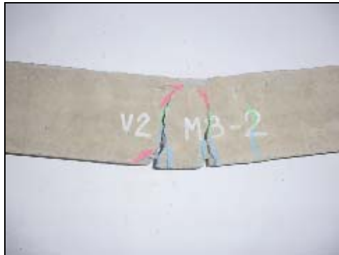
Foto 4.1 5 Grietas viga 1 modelo 3
