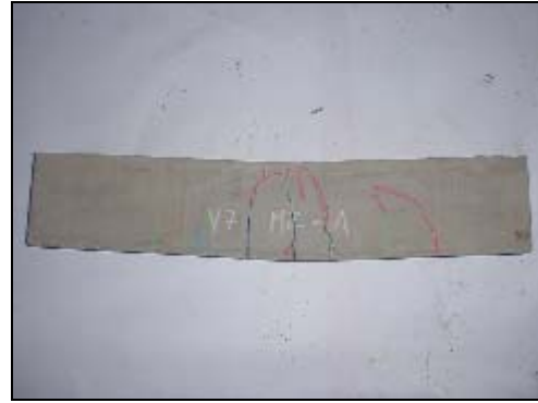
Foto 4.1 9 Grietas viga 2 modelo 2
