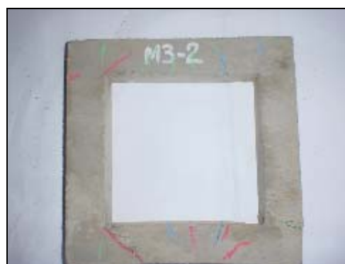
Foto 4.3 5 Grietas estructura 1 modelo 3
