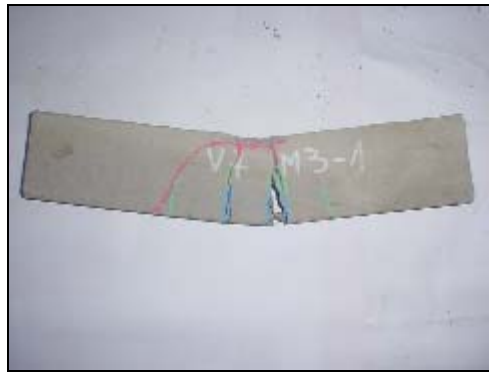
Foto 4.1 10 Grietas viga 2 modelo 3
