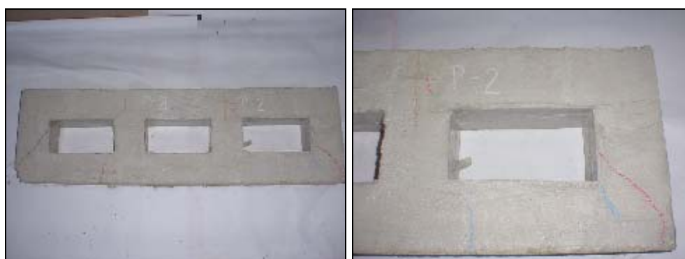
Foto 4.3 7 Grietas estructura 2 prototipo
