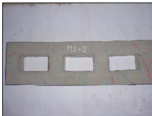
Foto 4.3 9 Grietas estructura 2 modelo 2
