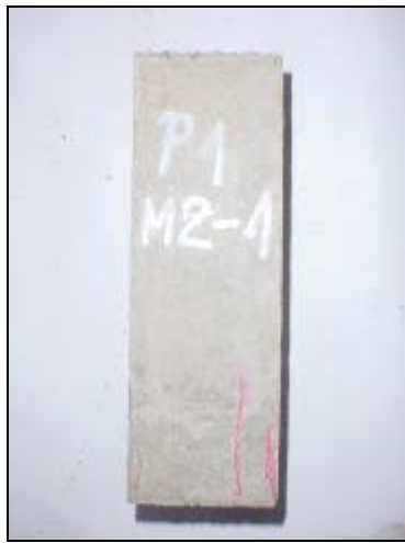
Foto 4.2 5 Grietas pilar modelo 2
