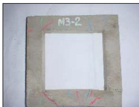
Foto 4.3 5 Grietas estructura 1 modelo 3
