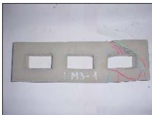
Foto 4.3 10 Grietas estructura 2 modelo 3
