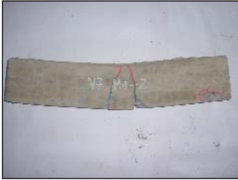
Foto 4.1 8 Grietas viga 2 modelo 1
