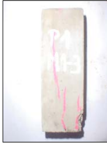
Foto 4.2 4 Grietas pilar modelo 1
