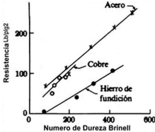
Fig.1-9. Relación entre la dureza y la resistencia.
