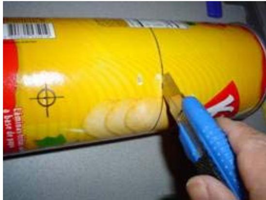
Después corte unos 20 mm desde la boca del pedazo restante es decir del lado en donde se pone la tapa plástica del envase y haga un corte transversal luego aplique **Cemento Caucho** a esta pieza y al extremo de la Guía.
