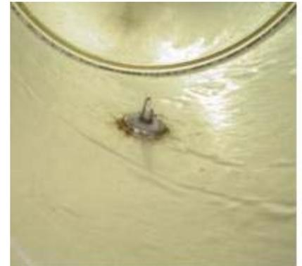
El material para este **elemento puede ser cobre o bronce** y la **soldadura** debe ser de buena calidad no utilice pasta para soldar. Corte el largo efectivo del elemento radiante utilice el pie de metro y un **buen alicate cortante**, acto seguido con **alcohol** limpie todo el Flux de la soldadura, el conector debe quedar limpio, es muy fácil que las microondas se atenúen o cortocircuiten por causa de la suciedad.
