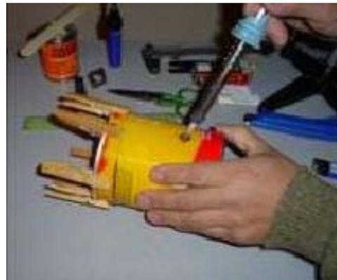
En las imágenes de izquierda a derecha podemos apreciar la perforación hecha con el cautil, se debe sacar con cuidado las rebabas de cartón quemado, se puede apreciar como queda dispuesto el conector y como se debe considerar el largo del elemento radiante de 1,5 mm de diámetro.
