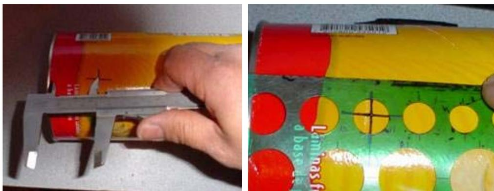
Medir el diámetro de la base del conector y marcar la perforación con una *reglilla*. Determinar el punto centro es muy importante como lo podrá apreciar al terminar la secuencia de imágenes.
