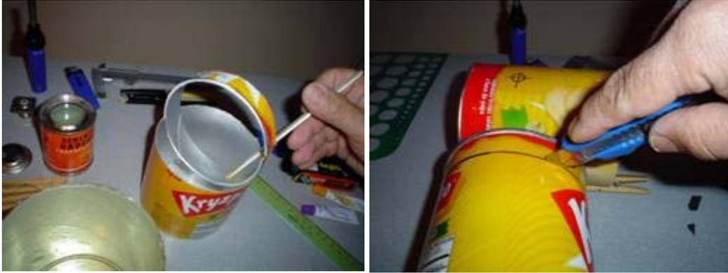
Pegar como indica la imagen y fijar con unas **pinzas para ropa**. Mientras el cemento caucho seca, con **un cautil de unos 80 Watt** bien caliente comience a hacer la perforación quemando desde el centro hacia fuera en la marca que corresponde a la perforación de la base del conector. **Hágalo con mucho cuidado para no dañar la Guía. Este paso también lo he realizado utilizando un taladro con una broca de la medida del conector y mucho cuidado.**
