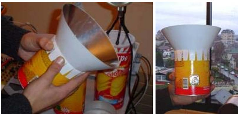
Aplicamos pegamento caucho a lo que será la abrazadera del embudo y a la lengüeta sobrante del embudo para después pegar y dejar fraguar unos 20 minutos sujetando la abrazadera con los elásticos para billetes como en la figura:
