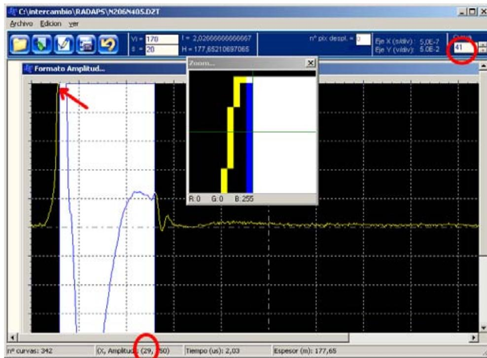
Fig 6.1: Medición de espesor en la curva 41 del archivo n206n405.dzt, con los mismos parámetros del cálculo con el proceso anterior.
