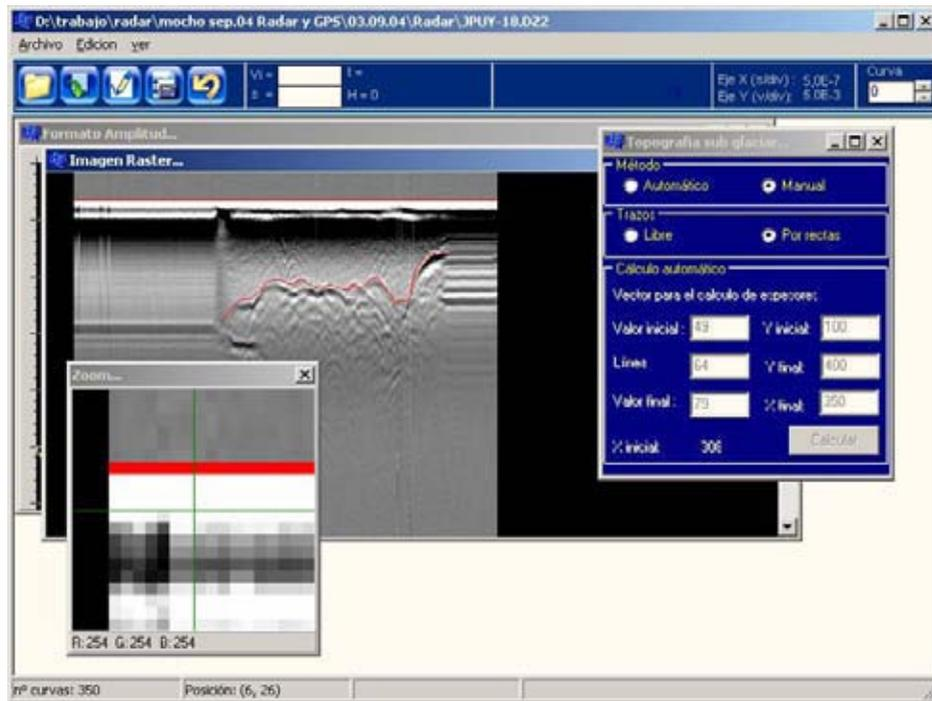
Fig. 5.17: Ventana con imagen raster y dibujo de topografía superficial y subglaciar.
