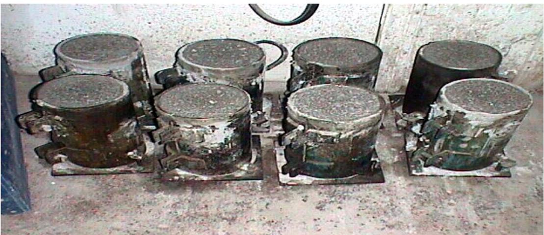
**Figura 4.4, Fotografía de moldes cúbicos, según NCh1017**
