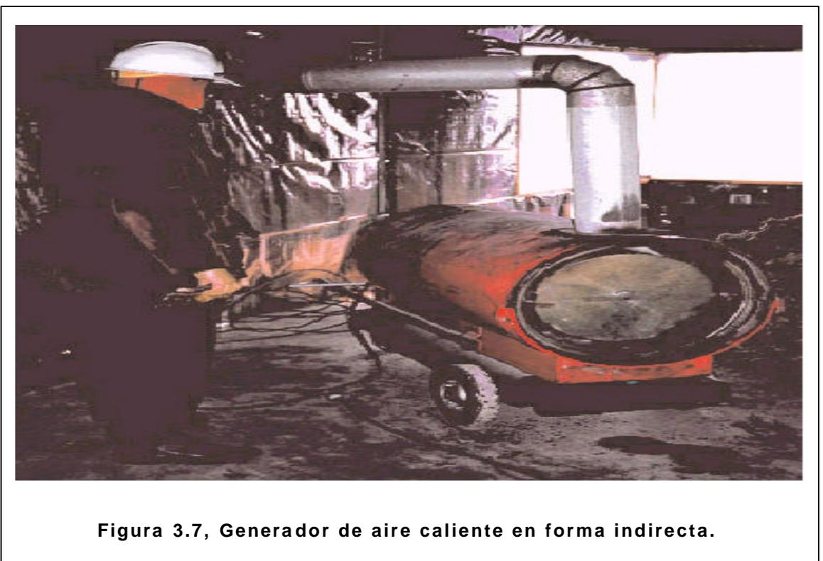
Figura 3.7, Generador de aire caliente en forma indirecta.
