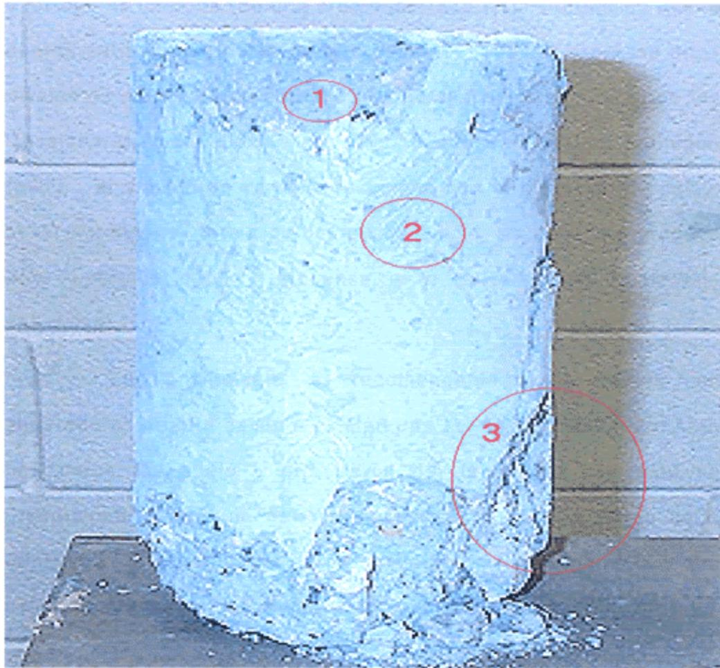
Figura 7.2, Daños producidos por ciclos de hielo y deshielo
