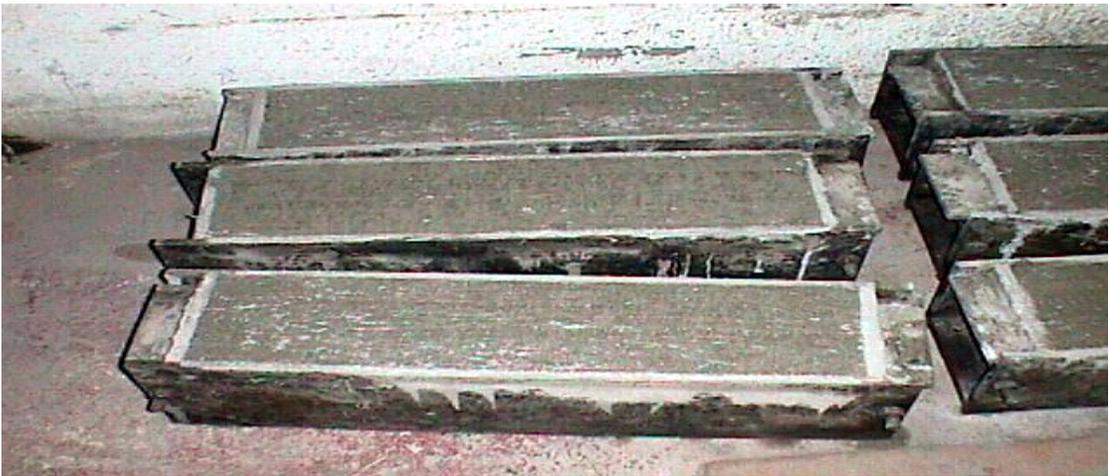
**Figura 4.3, Fotografía de moldes prismáticos, según NCh1017**
