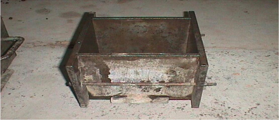
**Figura 4.2, Fotografía de un molde cúbico, según NCh1017**
