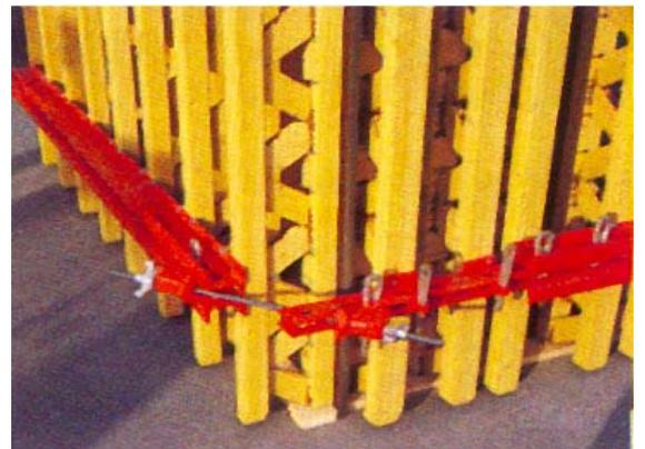
**Juntas entre paneles de compensación:** Se utiliza el mismo principio; las medidas restantes de hasta 125 cm de ancho se compensan de forma continua. Anclaje a través e la correa VARIO extendida. Distancia máxima de los anclajes 50 cm.
