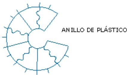
"Caluga plástica para mantener recubrimientos"
