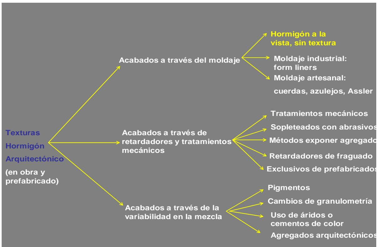
El análisis de la presente, se realizará con hormigón a la vista sin textura, el cual definiremos como: un hormigón armado, sin pigmentos solo de color gris, ni textura superficial, sin tratamientos abrasivos, mecánicos o retardantes de fraguado, y sin variar la mezcla.
