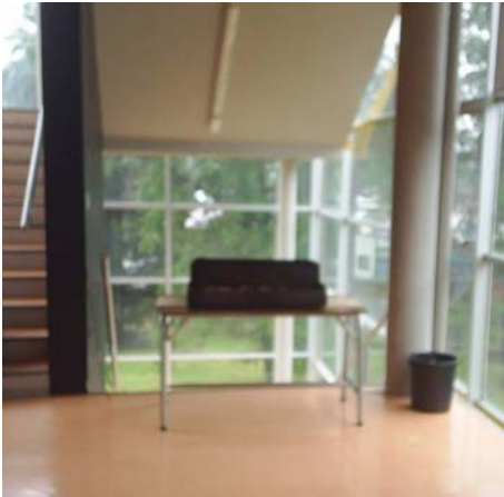
Tambor con aserrín y aceite quemado, ubicado sobre un mesón en un borde del pasillo, para producir humo.
