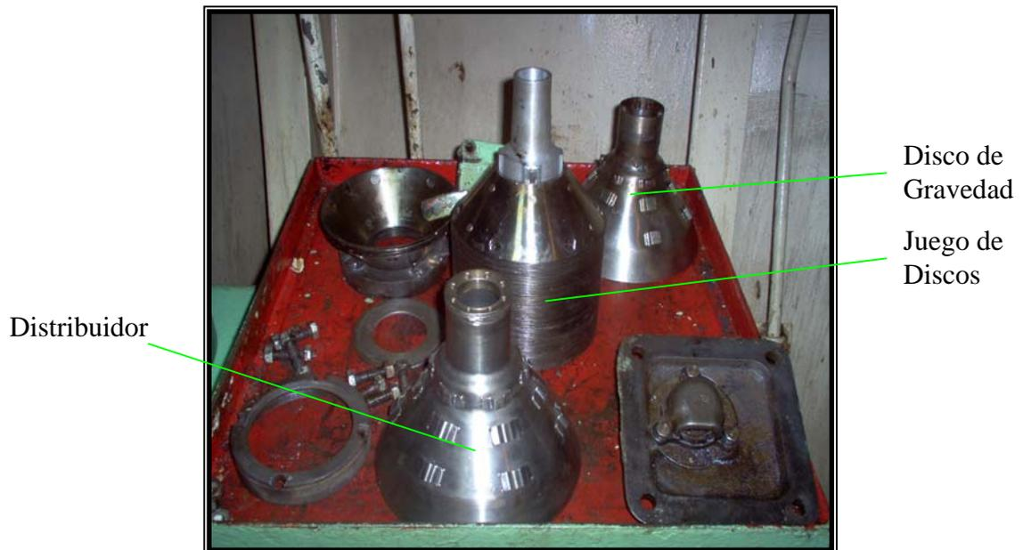
**Figura 39.- Juego de discos de un separador centrifugo.**
