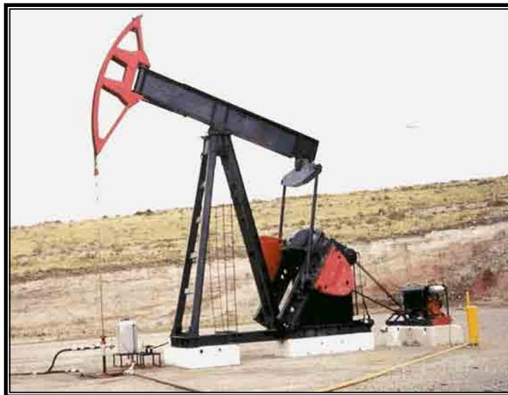
**Figura 12.- Sistema de bombeo mecánico.**
