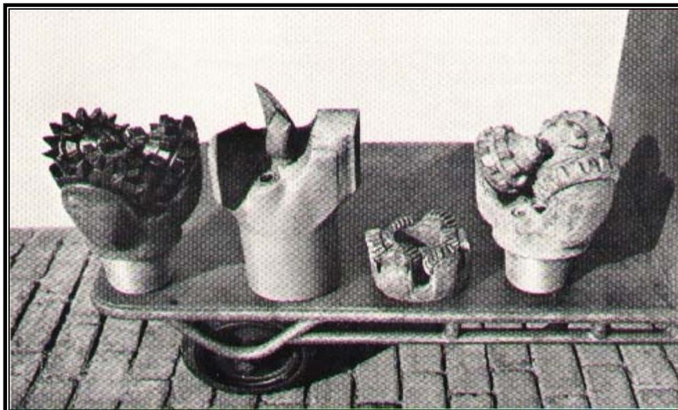
**Figura 10.- Diferentes tipos de brocas perforadoras**
