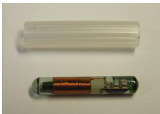
*Imagen 2:* Transpondedor inyectable
