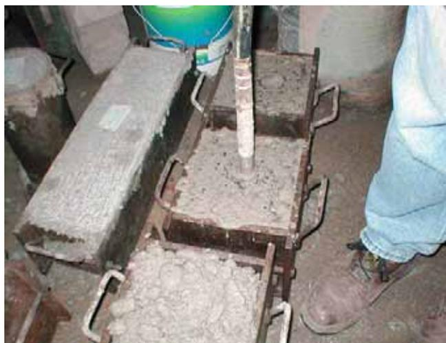
El curado inicial se realizó en el mismo lugar de confección de las probetas, las que se desmoldaron transcurrido un lapso aproximado (no inferior) de 20 horas después de realizado el hormigonado.
