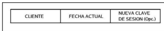
Figura 15: Formato de un autenticador de Kerberos
