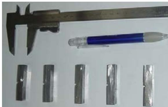
Fig. 3.15 Probetas ranuradas en v.
