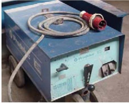
Fig. 2.9 Máquina de soldar.
