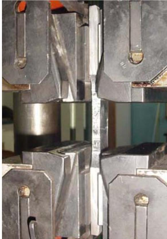
Fig. 3.4 Disposición de la probeta en la máquina.
