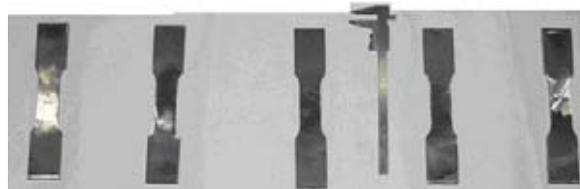
Fig. 3.3. Set de Probetas para ensayos de tracción.
