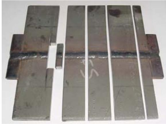
Fig. 2.22 Probetas obtenidas de la plancha.
