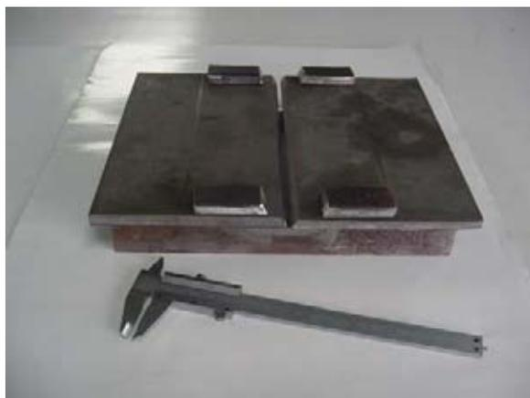
Fig. 2.7 Presentación de planchas que intervienen en la unión con sus respectivas planchas auxiliares.
