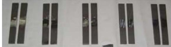
Fig. 3.6 Probetas para ensayo de doblado cara y raíz.
