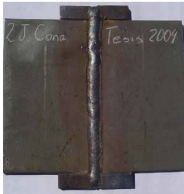
Fig. N° 2.18 Presentación cordón de terminación electrodo B.
