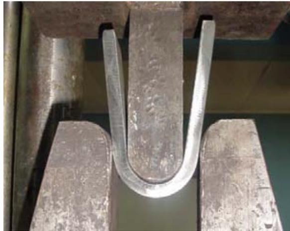
Fig. 3.8 Probeta con la aplicación de carga.
