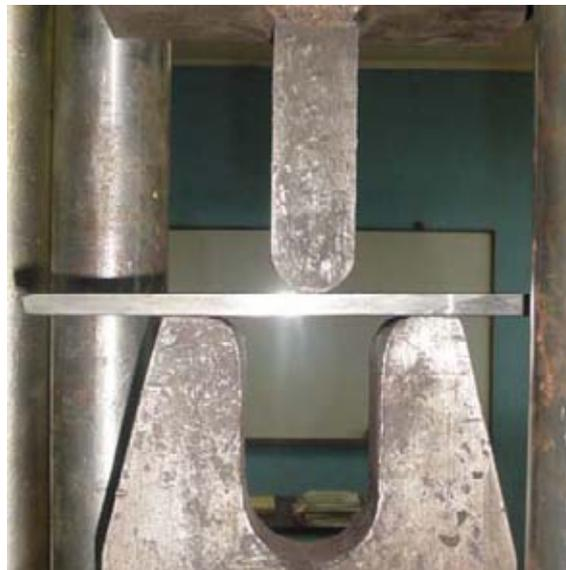
Fig. 3.7 Posición antes de aplicar la carga en su punto medio.
