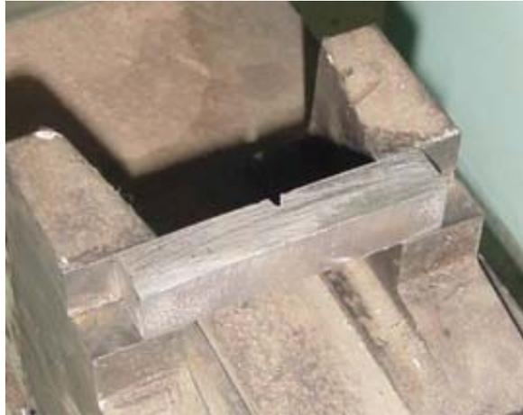
Fig. 3.11 Posición centrada de la probeta en el yunque.
