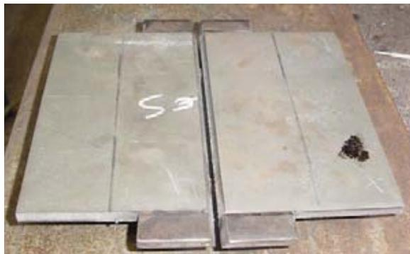
Fig. 2.10 Plancha lista para soldar en posición plana.
