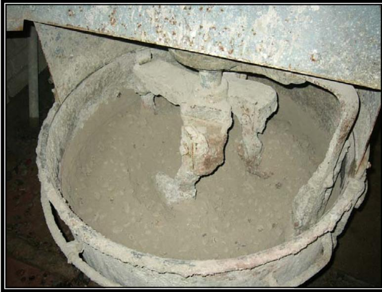
**Foto N° 28. Muestra el cambio que se produce de color cuando se le agregó el cemento.**
