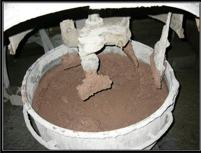
**Foto N° 5. Muestra como varía la tonalidad del color después de haber agregado el cemento y el agua.**
