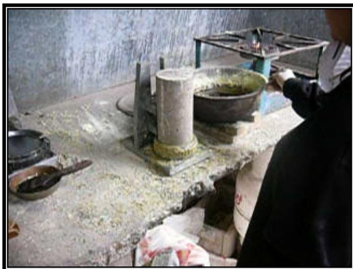
**Foto N°20. Refrentado de las probetas.**
