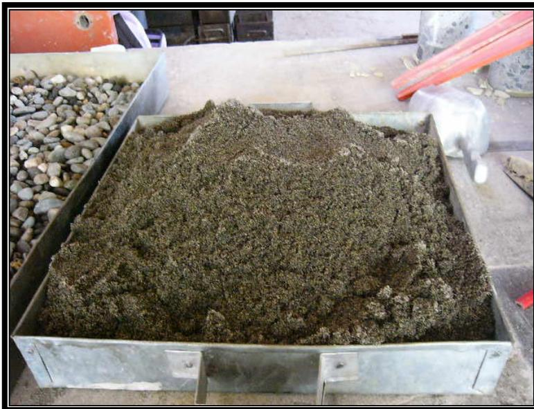
**Foto N° 1.- Arena lista para el uso en la preparación del hormigón, cumpliendo con las normas chilenas.**
