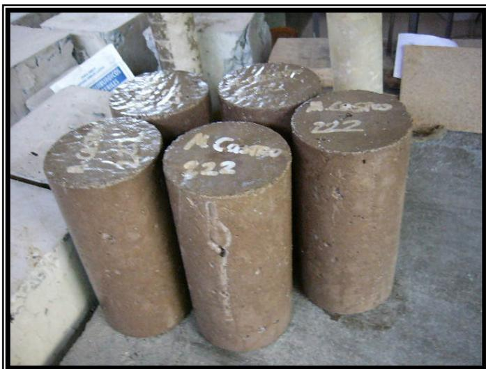
**Foto N° 7. Las 5 probetas recién sacadas de su saturación y antes de ser ensayadas.**
