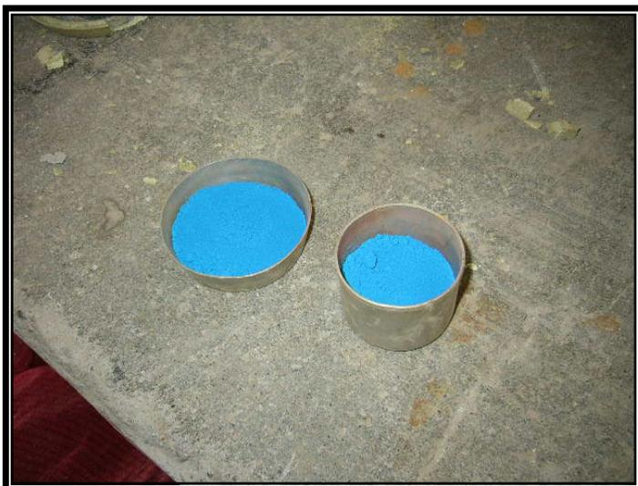
**Foto N° 12. Muestra el pigmento Azul luz 100, antes de agregarse a la betonera a mezclarse con los áridos.**
