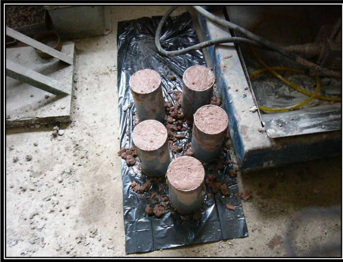
**Foto N° 25. Hormigón dentro de las probetas.**
