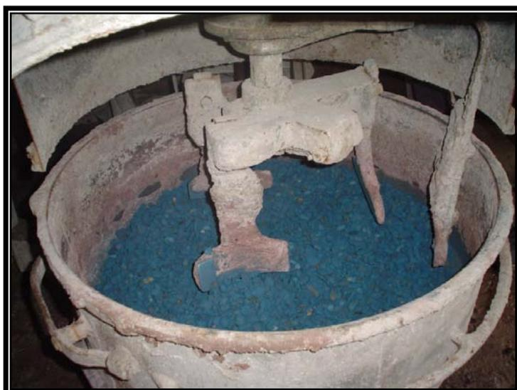
**Foto N° 13. Aquí se agregó el pigmento Azul luz 100 mientras se mezclaba la gravilla con la arena.**
