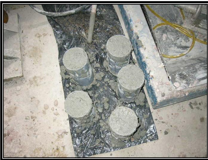
**Foto N° 34. Hormigón en las probetas de PVC, después de haber sido vibrado.**
