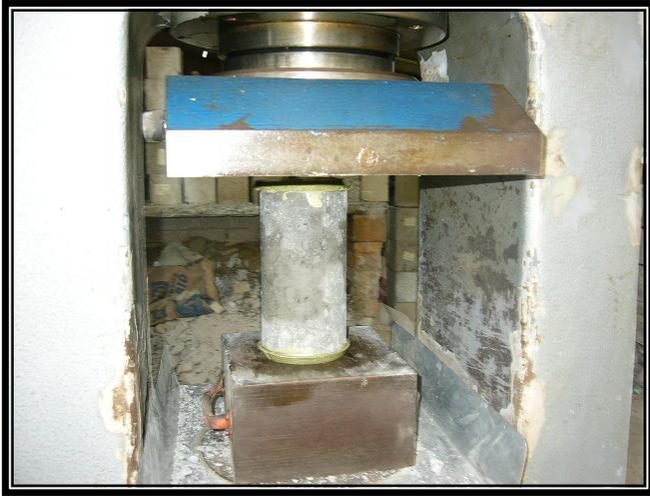
**Foto N°21. Ensayo de las probetas.**
