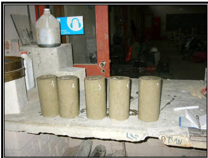
**Foto N° 23.** Las probetas de hormigón con pigmento 918, fueron sacadas de la piscina donde se estaban saturando y fueron medidas y pesadas.
