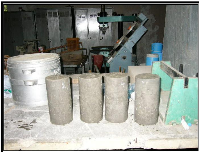
**Foto N°19. Hormigón con pigmento B. 318. Antes de ser refrentadas para sus posteriores ensayos.**
