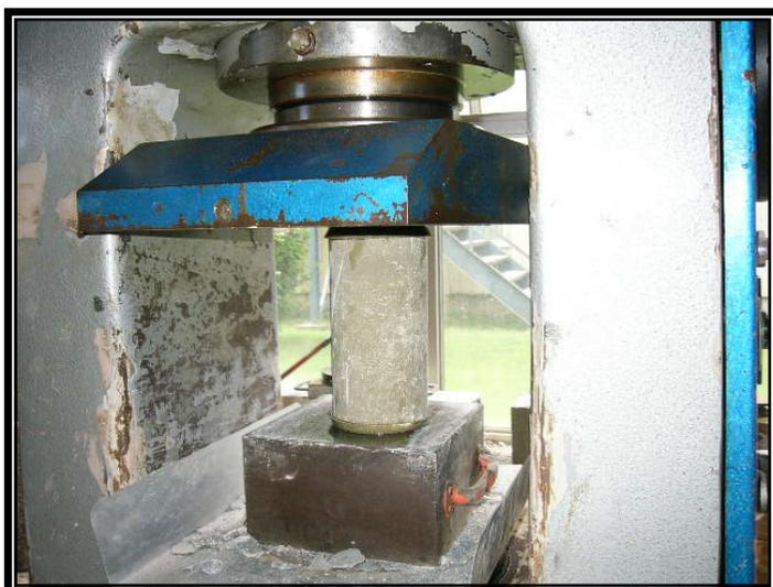
**Foto N° 24.** Las probetas están siendo ensayadas a compresión.
