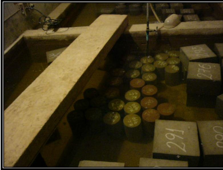
**Foto N°3. Probetas dentro de la piscina, durante 28 días antes de ser ensayadas.**
