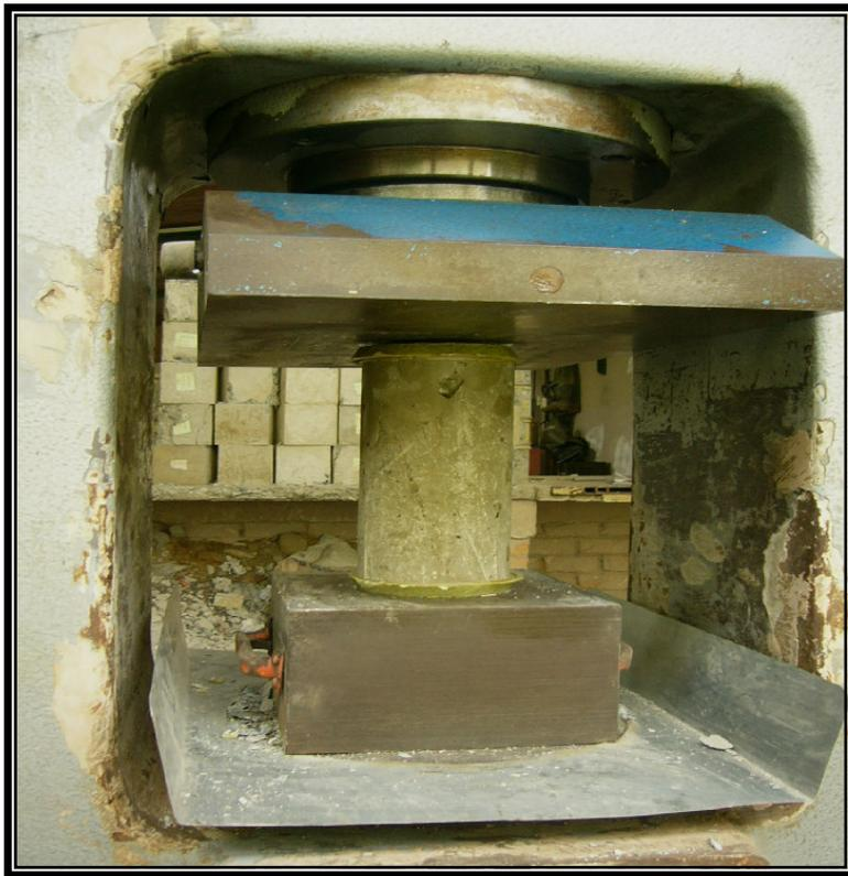
**Foto N° 18. El hormigón con pigmento 919, está siendo ensayado, para medir su compresión.**
