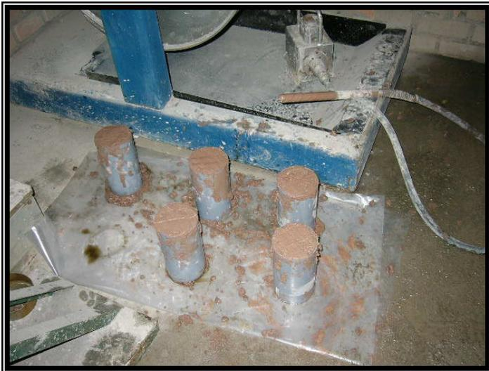
**Foto N° 6. Hormigón con pigmento, puesto en las 5 probetas, después del vibrado.**
