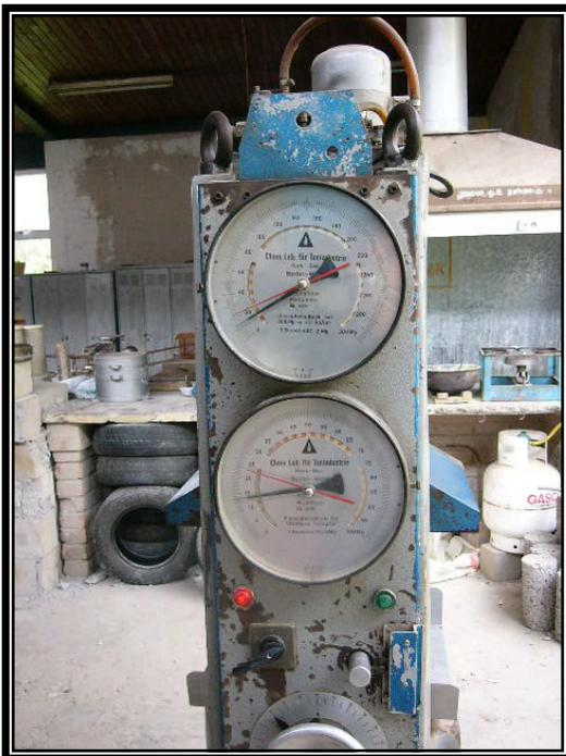
**Foto N°22. Muestra las cargas de la probeta, cuando esta siendo ensayada.**
