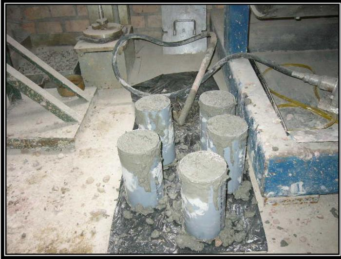
**Foto N° 35. Hormigón en las probetas de PVC, después de haber sido vibrado.**
