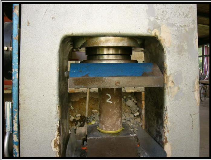
**Foto N° 9. Momentos en que la probeta esta siendo ensayada en la máquina de compresión.**
