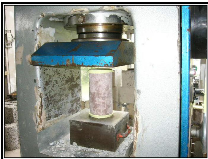
**Foto N° 16. Probeta de hormigón con pigmento 732.**
