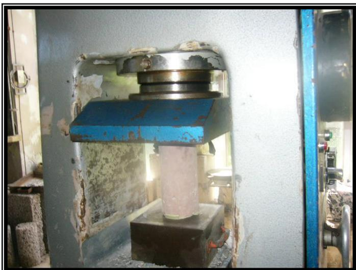
**Foto N° 11. Probeta esta siendo ensayada.**
