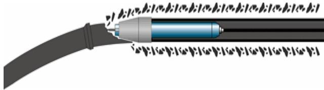
A menudo, las herramientas no pueden navegar curvas con un expansor delantero muy grande, en cambio herramientas más pequeñas de Grundocrack, con los ampliadores posteriores pueden navegar mejor las curvas de la tubería anfitriona. Una cabeza de guía del schnoze es también eficaz cuando está utilizada con los expansores posteriores.
