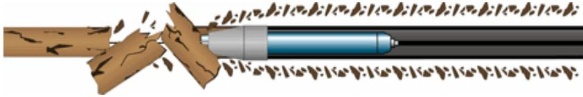
En un trabajo normal, la vieja tubería debe ser retirada hacia fuera mientras se realiza el proceso de reemplazo. Sin embargo, ciertos tipos de suelos y materiales de la tubería anfitriona, son de un gran mayor tamaño. En estos casos severos, estos restos de material pueden causar la obstrucción y posiblemente el atasco de la herramienta.
