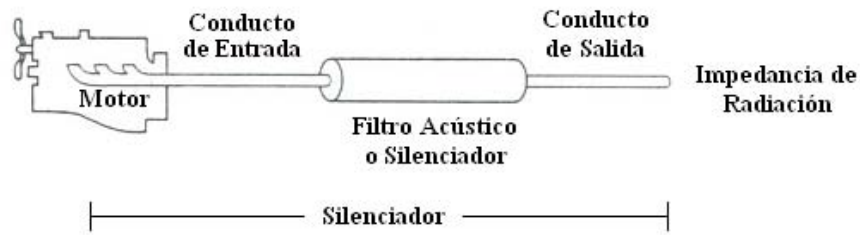
Figura 3: Silenciador típico de escape [2].
