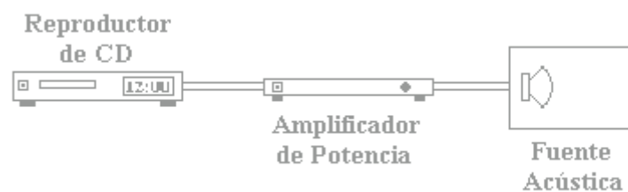
Figura 15: Esquema del sistema para la generación de señal.
